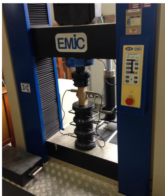
Figura 28 - Ensaio de compressão paralela na máquina universal de ensaios mecânicos
