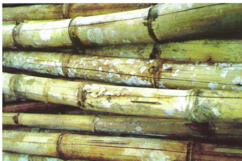
Figura 4 - Rachaduras em conseqüência de armazenagem inapropriada, seguida de ataque de fungos Fonte: Liese e Kumar (2003).
