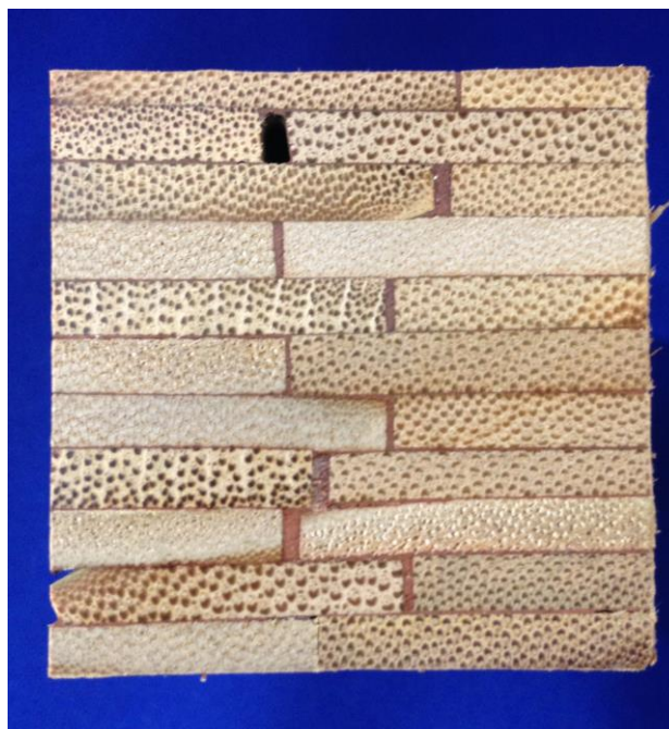
Figura 23 - Seção transversal de uma viga
