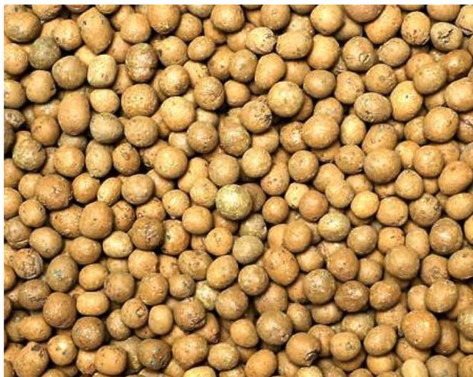
**Figura 2 - Argila Expandida diâmetro máximo de 15 mm.**
