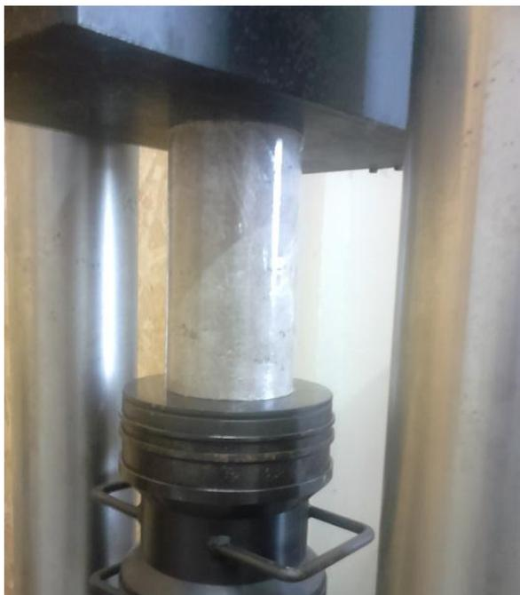
**Figura 16 – Corpo de prova durante o ensaio de compressão**
