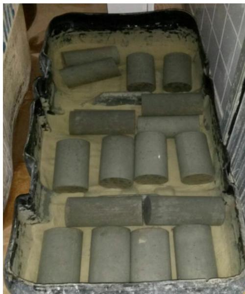
**Figura 14 – Corpos de prova em cura.**
