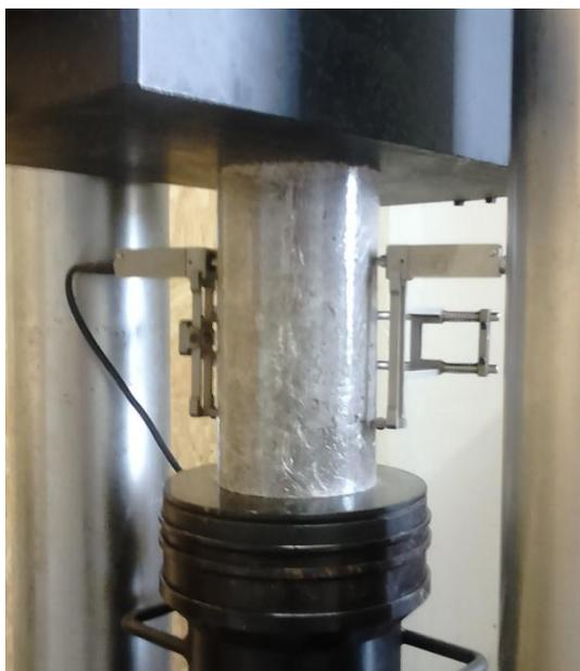
**Figura 18 - Ensaio de Módulo de Elasticidade**
