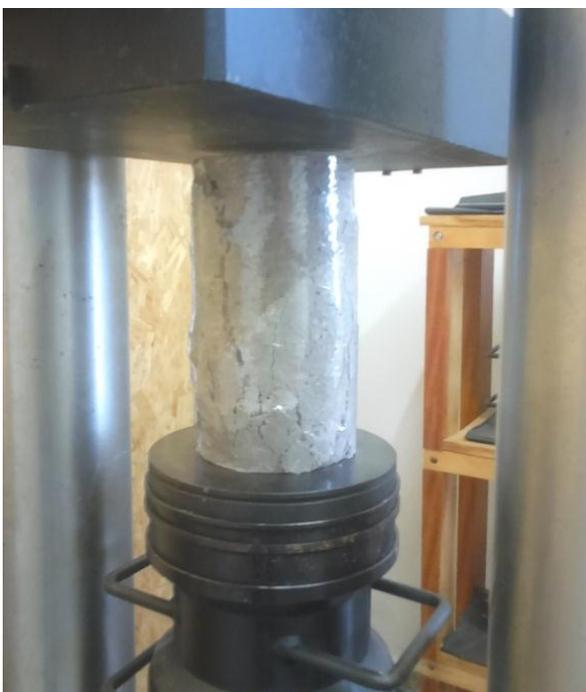
**Figura 17 – Corpo de prova após o ensaio de compressão**
