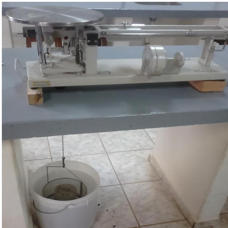
**Figura 19 - Pesagem com o corpo de prova imerso**
