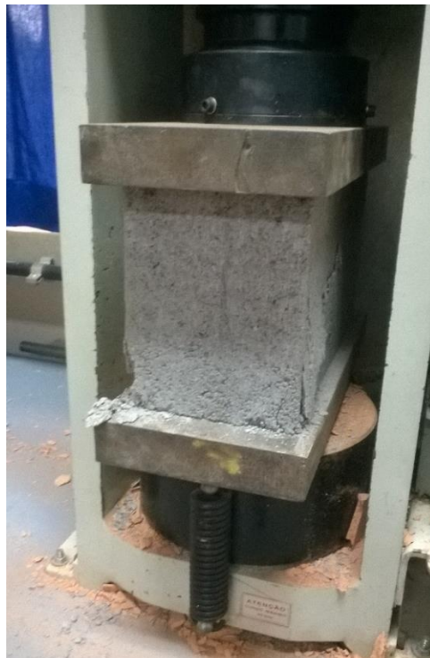
Figura 21- Ruptura do bloco de concreto
