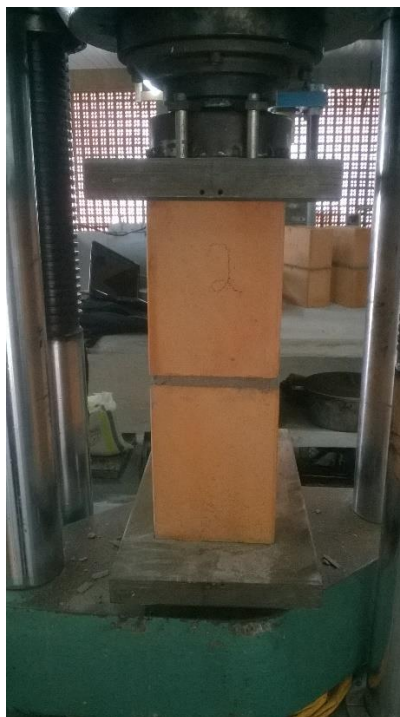
Figura 16 - Prisma cerâmico submetido à ensaio de compressão. Fonte: Autoria própria.
