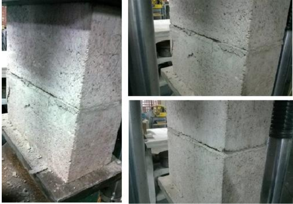
Figura 23 – Modo de ruptura: prismas de concreto Fonte: Autoria própria.
