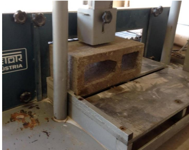
Figura 10 - Retífica dos blocos de concreto. Fonte: Autoria própria.
