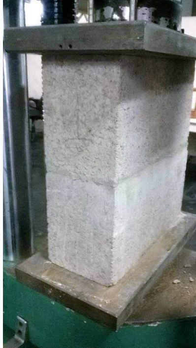
Figura 19- Prisma de concreto submetido à ensaio de compressão. Fonte: Autoria própria.
