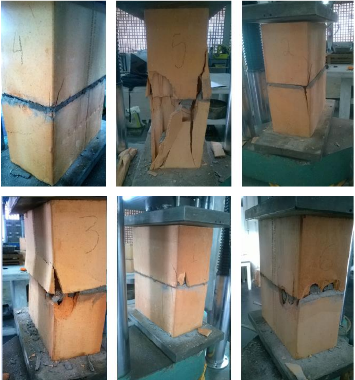
Figura 22 - Modo de ruptura: prismas cerâmicos. Fonte: Autoria própria.
