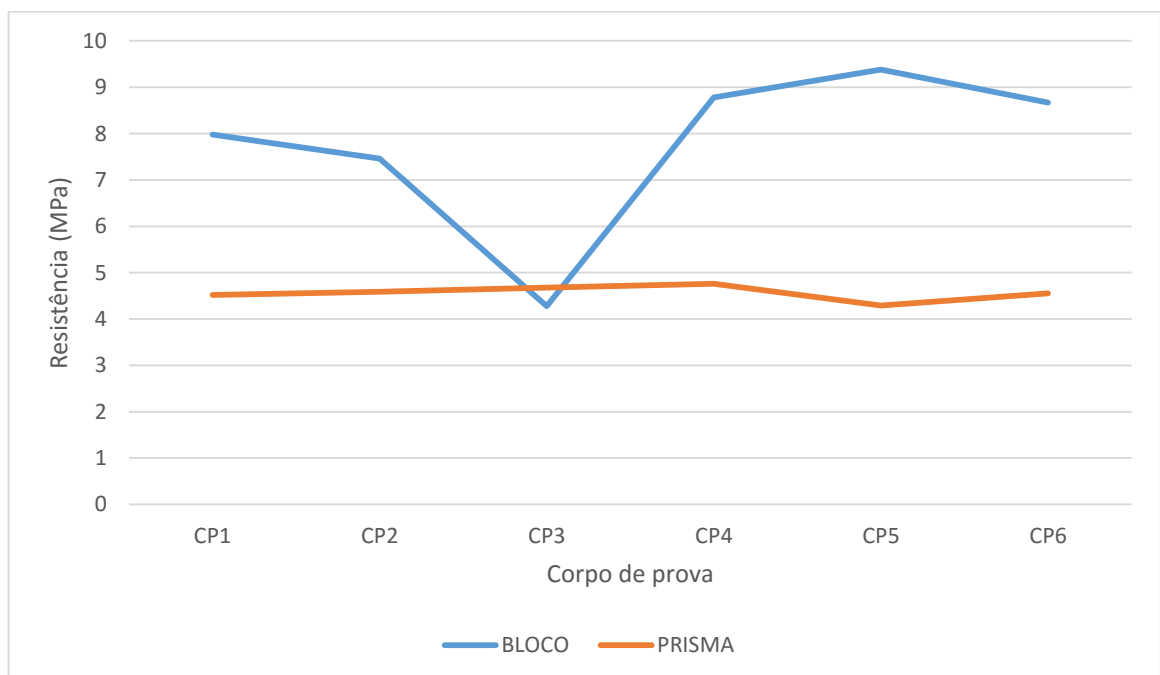
Gráfico 6 - Resistência à compressão: bloco de concreto x prisma de concreto. Fonte: Autoria própria.
