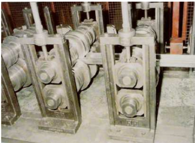
Figura 1 – Fabricação por perfilagem de perfis seção Ue. Fonte: Trebilcock,1994, apud Crasto, 2005, s/p.
