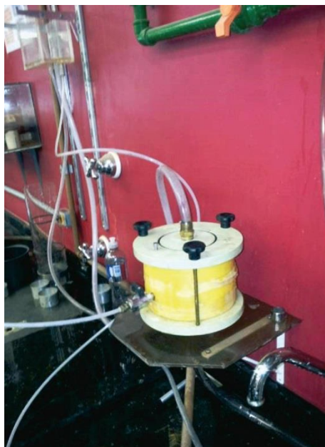
Figura 3 - Permeômetro de carga constante Fonte: Batezini e Balbo (2015)
