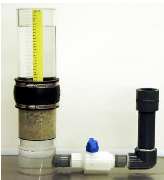
Figura 5 - Aparelho para medição da condutividade hidráulica. Fonte: Neithalath et al. (2003)
