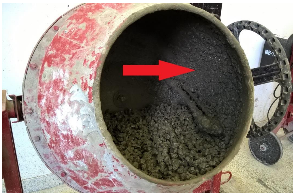
Figura 19 - Aderência do concreto nas paredes internas do tambor Fonte: Autoria própria (2016)
