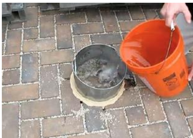
Figura 4 - Coeficiente de permeabilidade por anel de infiltração Fonte: Marchioni e Silva (2011)
