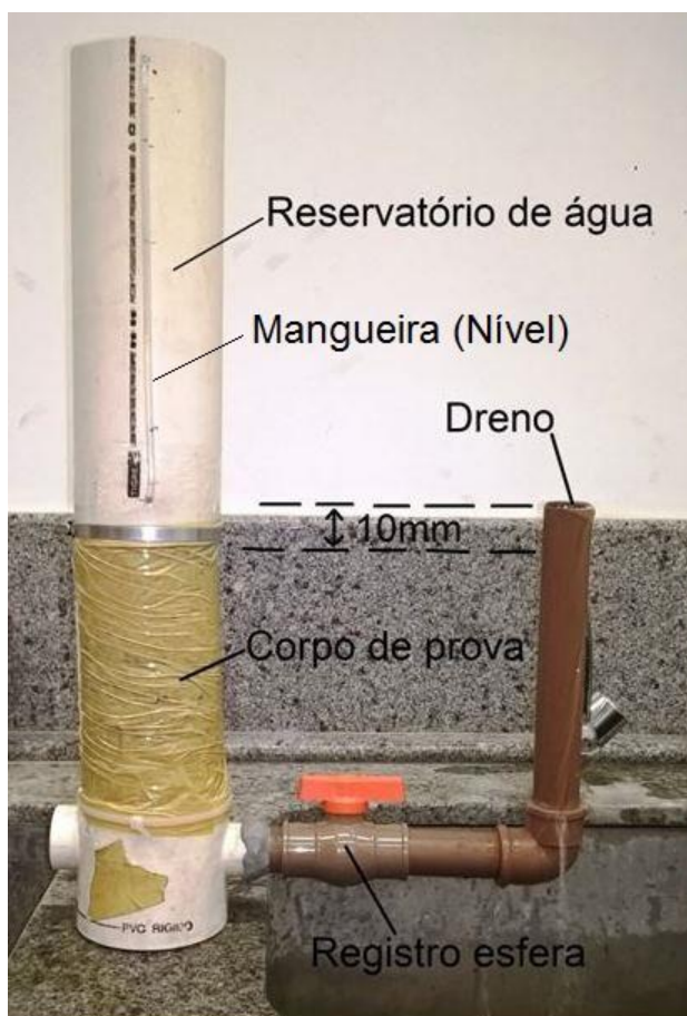
Figura 18 - Partes do permeômetro de carga variável Fonte: Autoria própria (2016)
