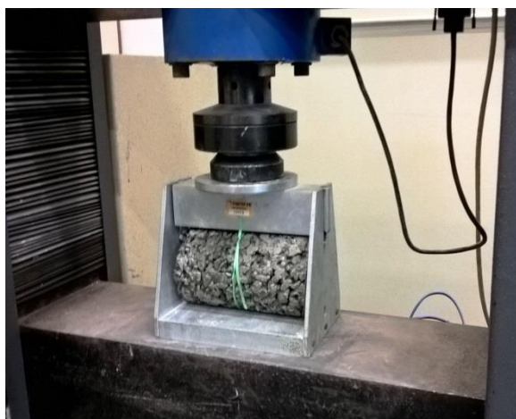
Figura 13 - Ensaio de tração por compressão diametral Fonte: Autoria própria (2016)
