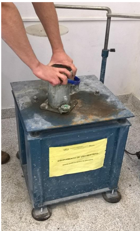
Figura 8 - Equipamento Vebe Fonte: Autoria própria (2016)
