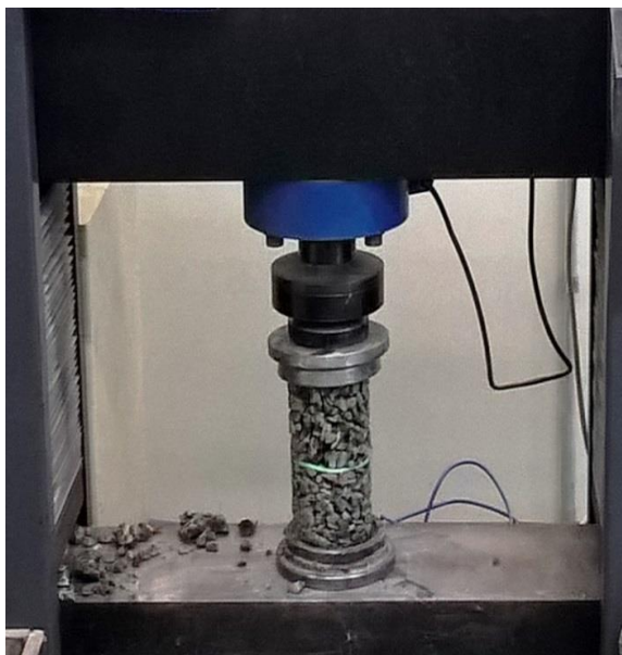
Figura 11 - Ensaio de compressão axial Fonte: Autoria própria (2016)
