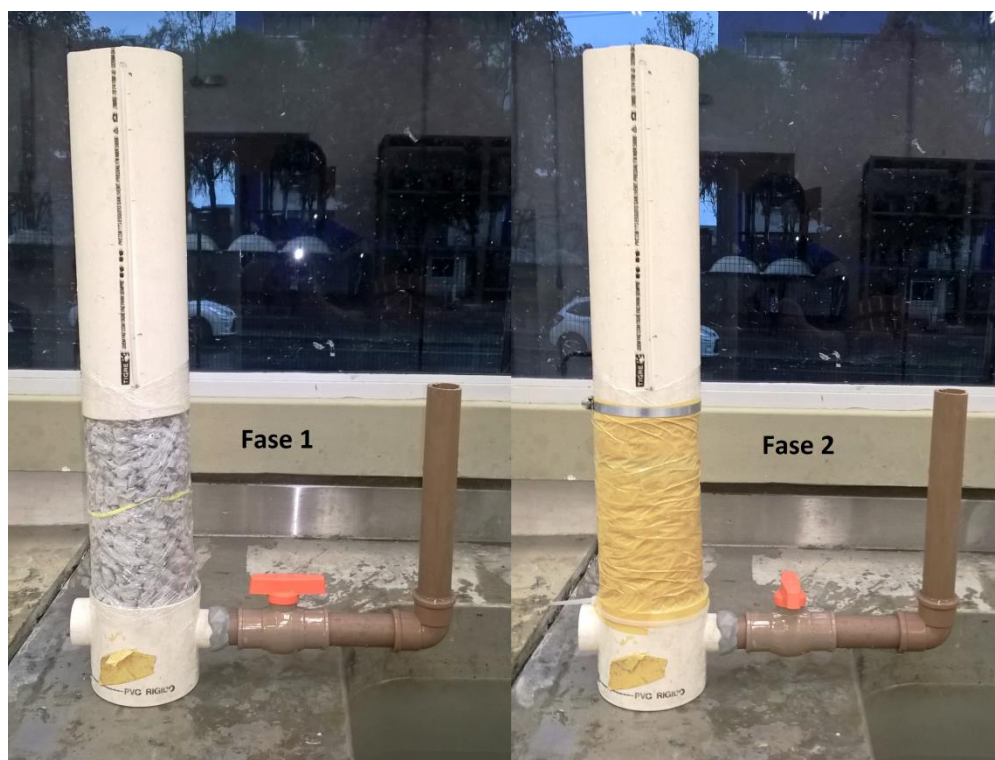
Figura 17 - Permeâmetro de carga variável Fonte: Autoria própria (2016)
