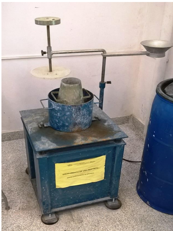
Figura 10 - Ensaio Vebe Fonte: Autoria própria (2016)
