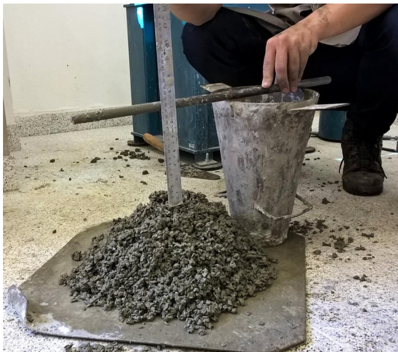
Figura 9 - Slump test Fonte: Autoria própria (2016)
