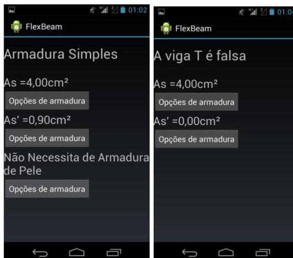
Figura 17. Tela de Saída dos dados da armadura de flexão (a)Viga Retangular (b)Viga T
