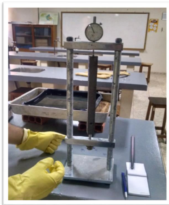
Figura 19 - Leitura dos prismas, em concordância com a NBR 15577-4 Fonte: Própria autoria
