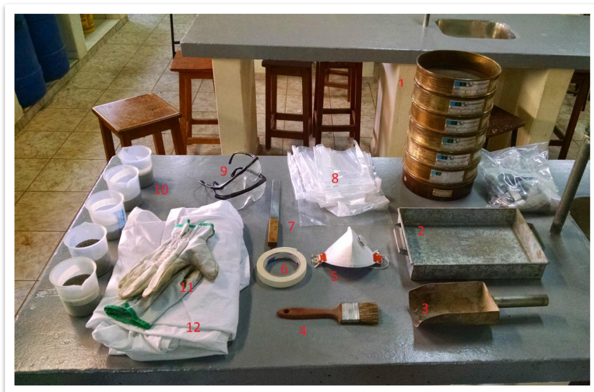
Figura 14 - Conjunto de itens utilizados no preparo da argamassa Fonte: Própria autoria
