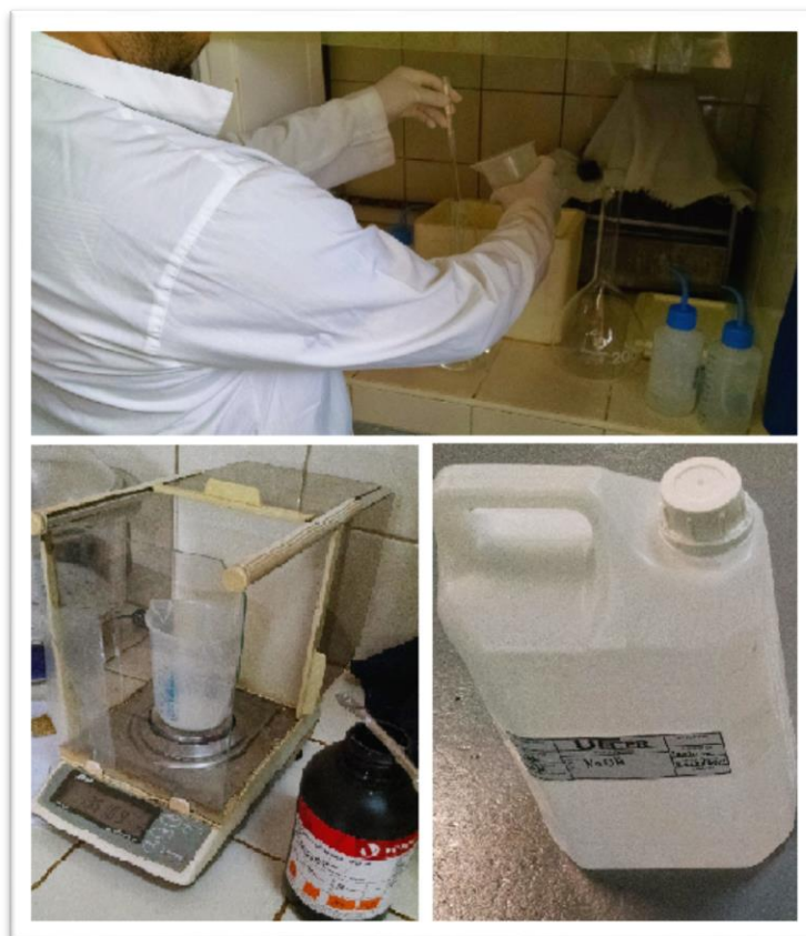
Figura 18 - Preparo da solução de NaOH Fonte: Própria autoria
