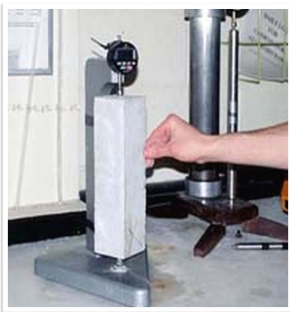
Figura 11 -Medição do comprimento inicial do prisma, segundo ASTM C1260 Fonte: US Department of Transportation (2014)
