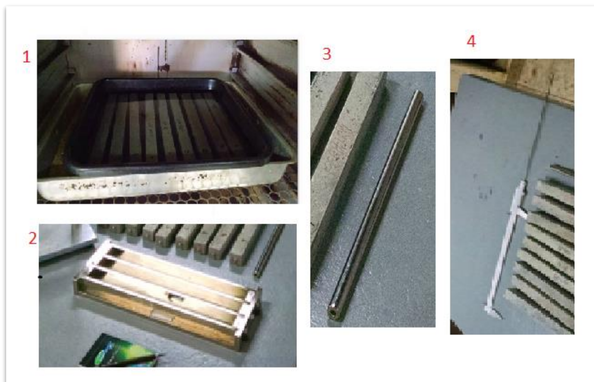
Figura 15 -Molde para corpos-de-prova, conforme NBR 15577-4 Fonte: Própria autoria
