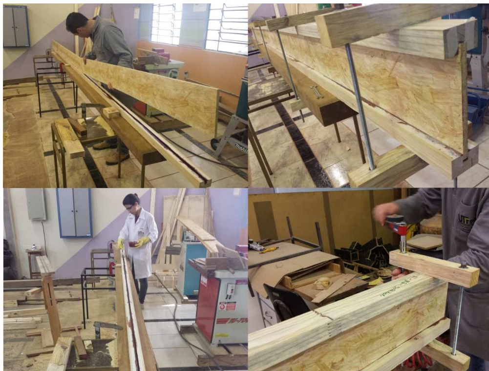
Figura 24 - Colagem das vigas.
