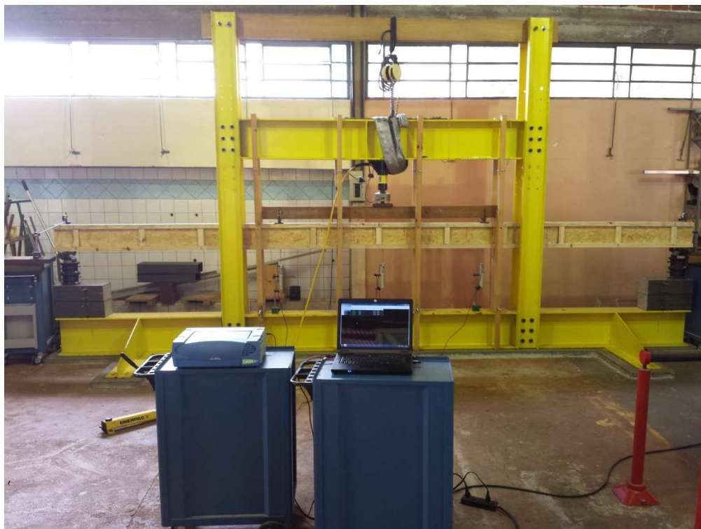
Figura 28 - Pórtico de reação.
