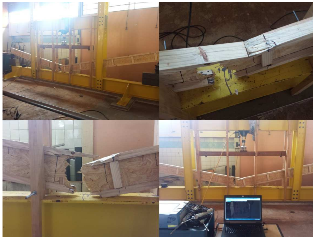
Figura 30 - Ruptura da viga "I".
