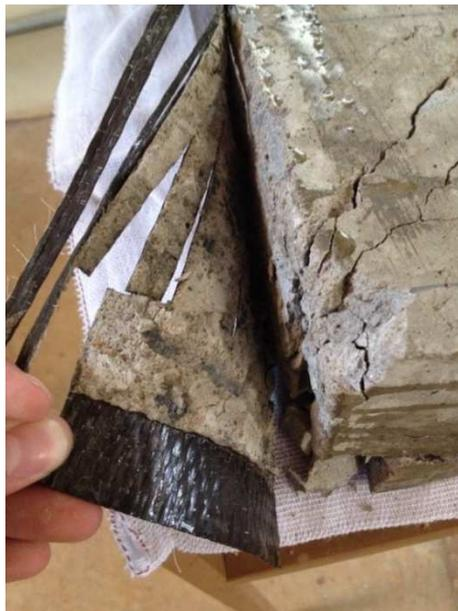
**Figura 24: Viga de concreto armado com o reforço de fibra de carbono rompida sem haver deslizamento do reforço estrutural.**
