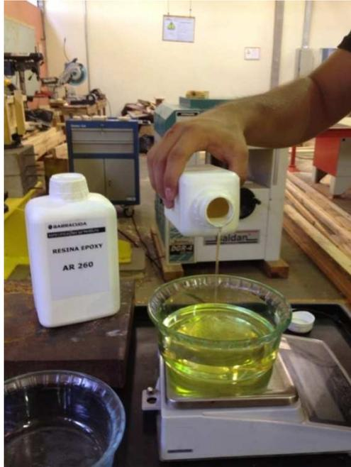
**Figura 14: Dosagem da resina epóxy e do endurecedor.**
