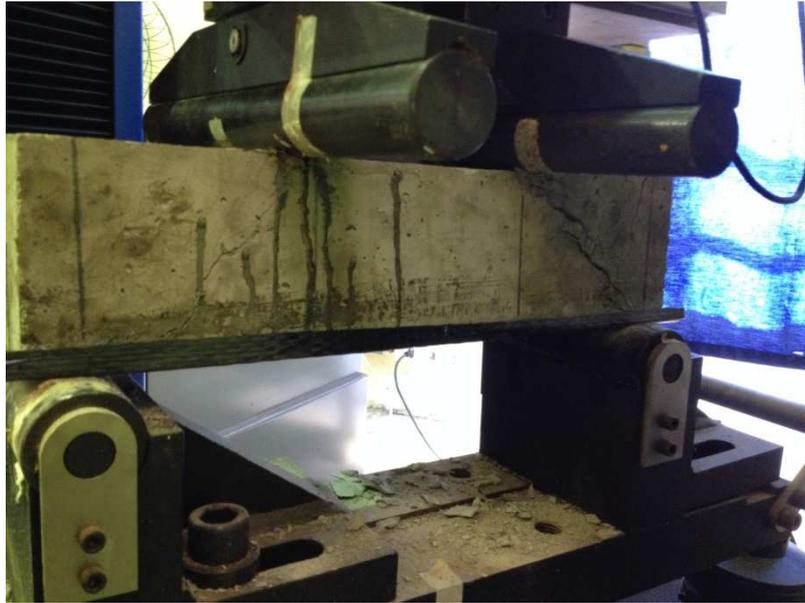
**Figura 22: Ruptura por cisalhamento do corpo de prova com armadura de diâmetro de 8,0mm reforçado com manta de fibra de carbono.**
