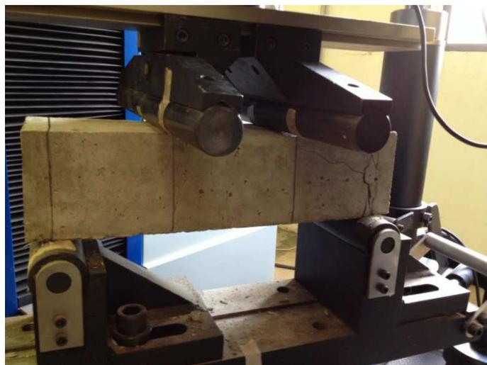
**Figura 21: Ruptura por cisalhamento do corpo de prova com armadura de diâmetro de 8,0mm sem a manta de fibra de carbono.**
