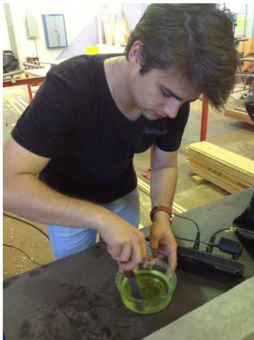
**Figura 15: Mistura da resina epóxy AR 260 com o endurecedor.**
