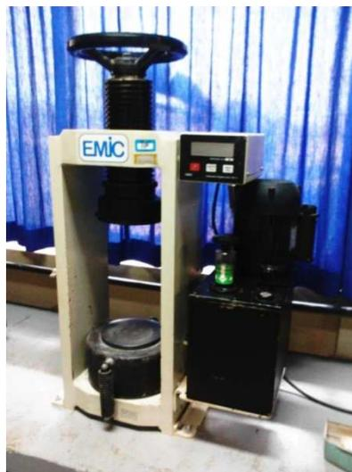
**Figura 23 - Prensa para ensaios de corpos de prova para verificação do  $f_{ck}$  do concreto.**
