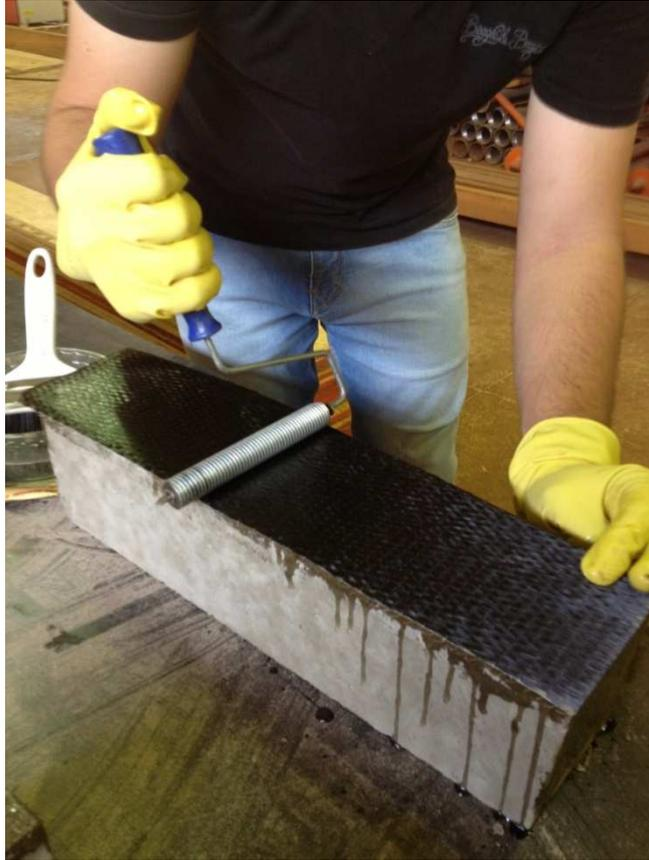
**Figura 17: Aplicação do tecido de fibra de carbono nos corpos de prova com o auxílio de um rolo.**
