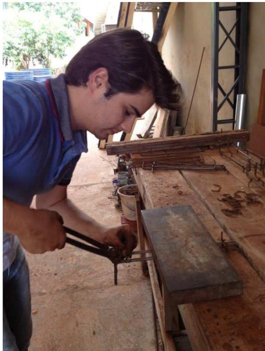
**Figura 8: Armação das armaduras dos corpos de prova.**
