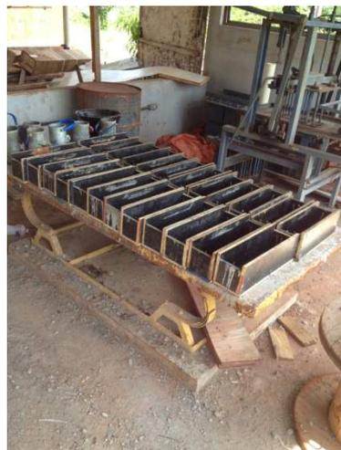
**Figura 12: Formas com as armaduras dispostas em cima da mesa vibratória, na eminência de serem concretadas.**
