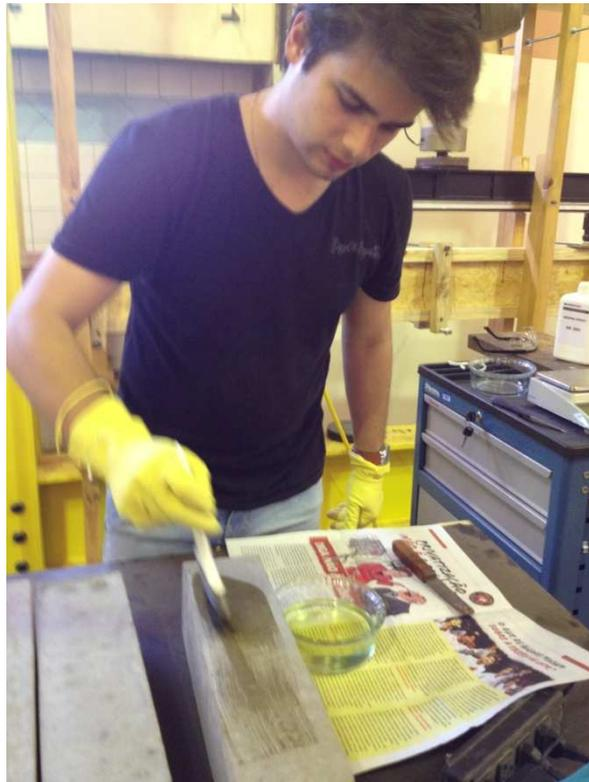
**Figura 16: Aplicação da primeira camada de matriz epoxídica nos corpos de prova.**
