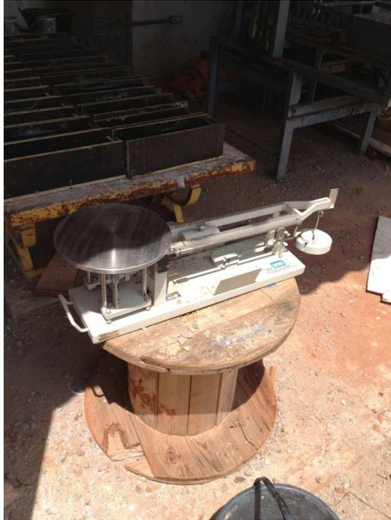
**Figura 10: Balança utilizada para a pesagem dos materiais na concretagem dos corpos de prova.**
