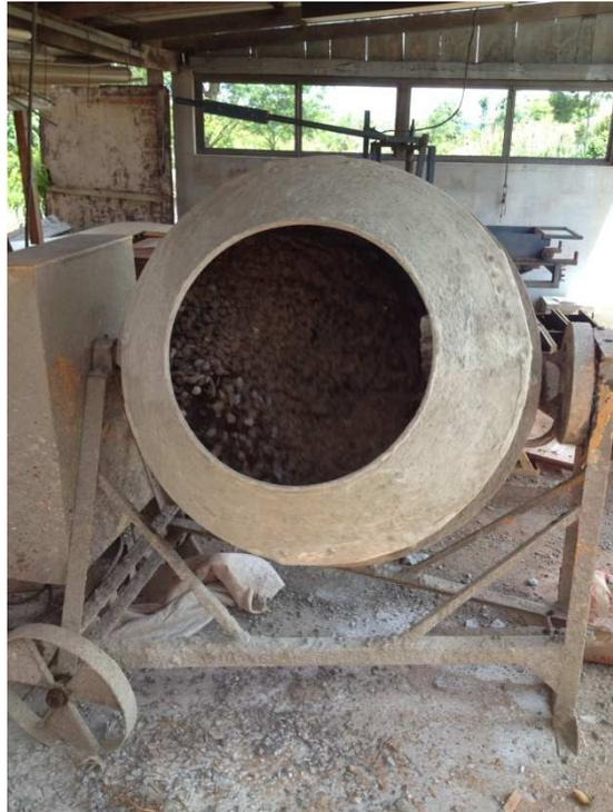
**Figura 11: Betoneira de eixo inclinado utilizada para a mistura do concreto.**
