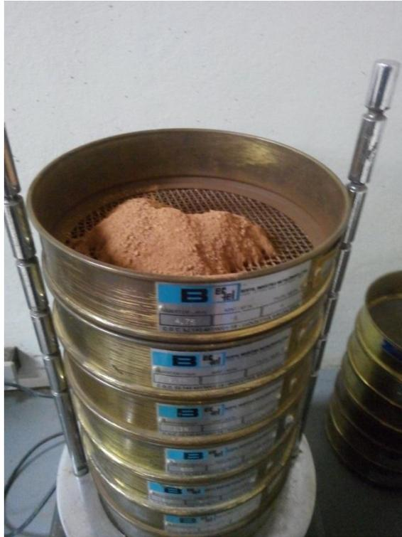
**Fotografia 13 - Série de peneiras sendo colocada no peneirador automático.**
