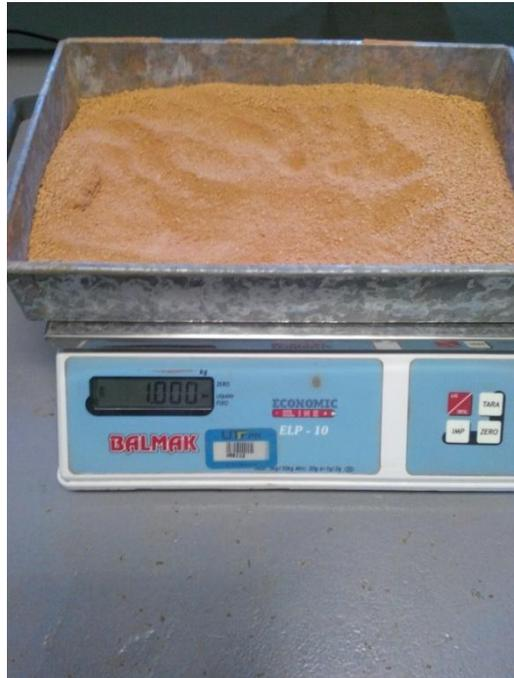
**Fotografia 8 - Balança com a amostra de exatamente 1000 gramas.**
