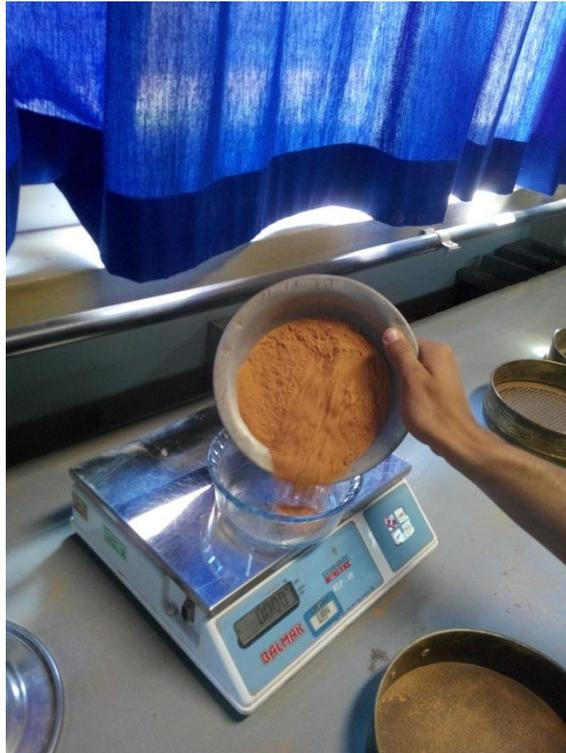
**Fotografia 19 - Pó cerâmico sendo depositado em recipiente adequando para pesagem.**
