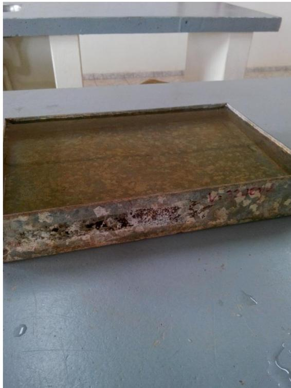
**Fotografia 23 - Recipiente paralelepípedo com volume de 3 dm<sup>3</sup> cheio de água para confirmação do volume.**
