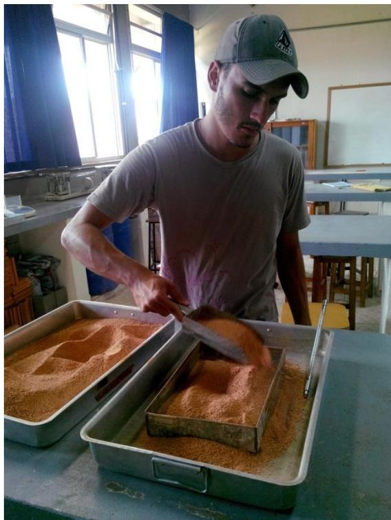
**Fotografia 28 - Lançamento do resíduo cerâmico com uma altura de 15 cm da borda.**
