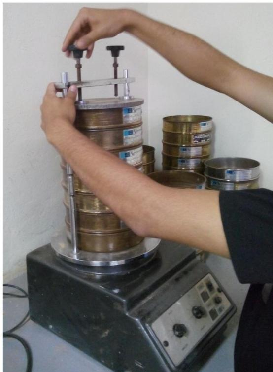
**Fotografia 14 - Preparativos para iniciar o peneiramento com o equipamento.**
