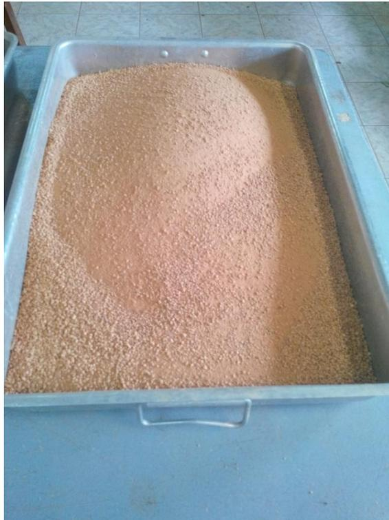
**Fotografia 26 - Amostra de resíduo cerâmico utilizada no ensaio.**
