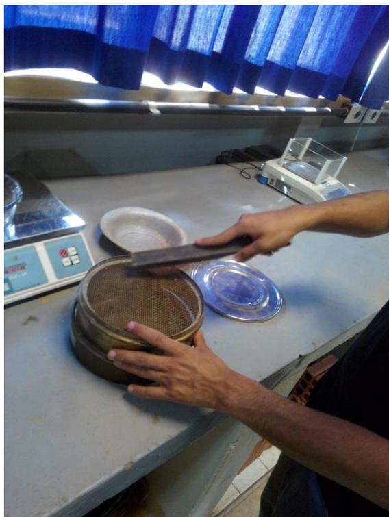
**Fotografia 16 - Limpeza das partículas que ficam presas na peneira utilizando escova, para que não se altere significativamente a amostra.**
