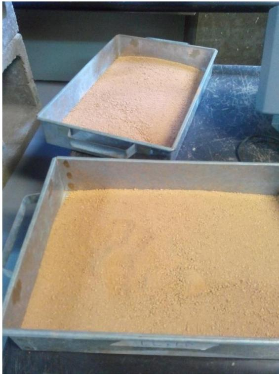
**Fotografia 10 - Modelo das amostras e formas utilizadas para armazenamento.**
