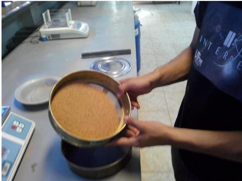
Fotografia 18 - Material sendo retirado da peneira para passar por pesagem.
