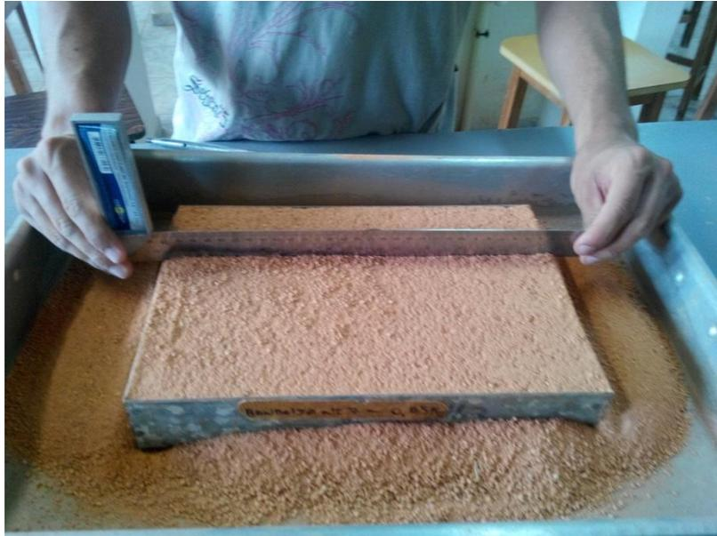
**Fotografia 29 - Alisamento da superfície com auxílio de um esquadro.**
