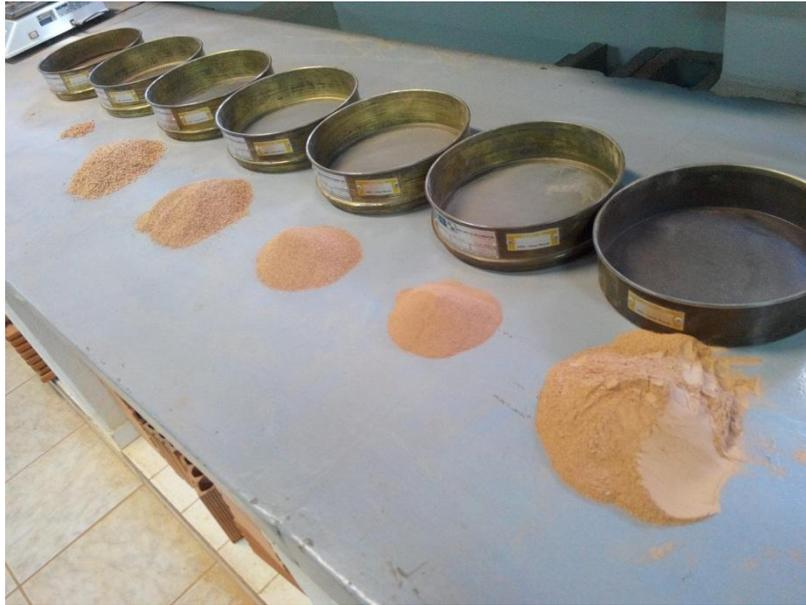
**Fotografia 22 - Divisão granulométrica de uma das amostras.**
