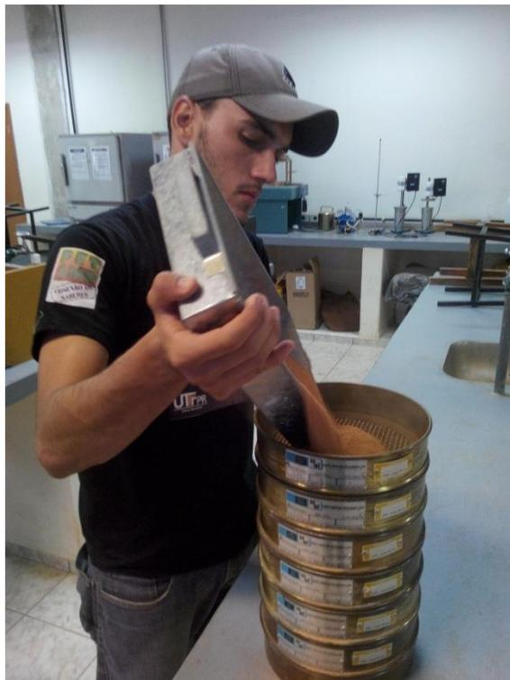
**Fotografia 12 - Amostra sendo colocada na série de peneiras.**
