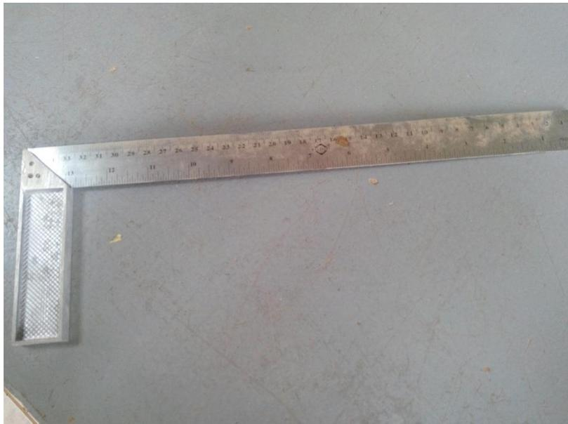
**Fotografia 25 - Esquadro utilizado para alisar a superfície da forma.**
