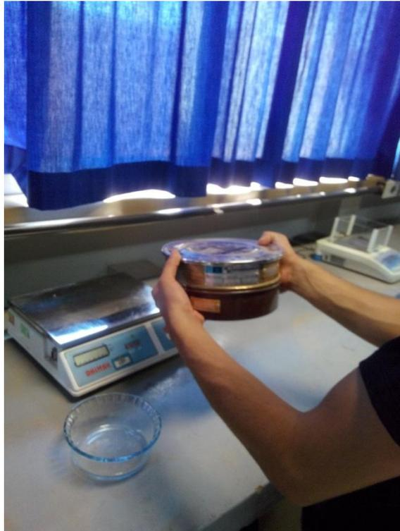
**Fotografia 15 - Peneiramento manual após o mecânico, visando otimizar o ensaio.**
