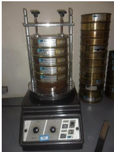
**Fotografia 3 - Série de peneiras normal montada no peneirador automático.**
