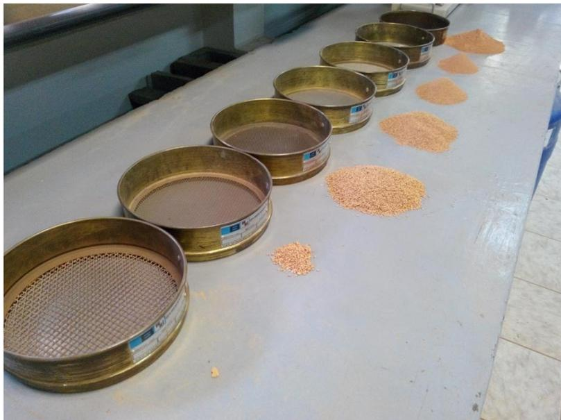
**Fotografia 21 - Detalhe das porções retidas em cada peneira de uma determinada amostra.**
