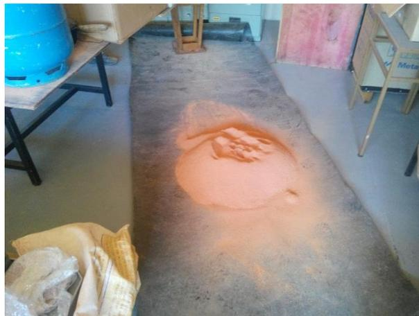
**Fotografia 7 - Formação do cone com parte superior achatada.**
