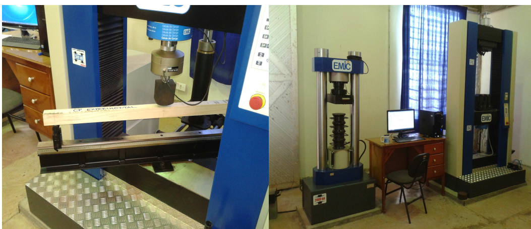
Fotografia 11: Máquina Universal EMIC utilizada nos ensaios Fonte: Autoria própria.
