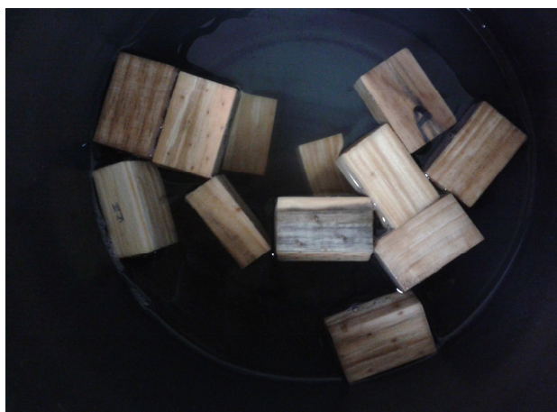
Fotografia 6: Corpos de prova imersos em água para obtenção da densidade básica da madeira
