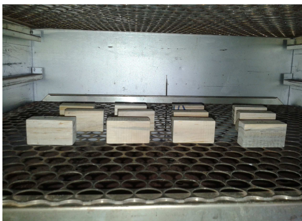
Fotografia 5: Secagem dos corpos de prova em estufa para determinação do teor de umidade Fonte: Autoria Própria.
