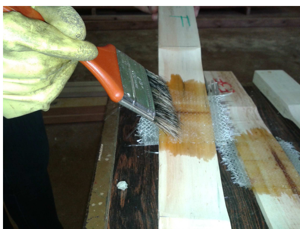
Fotografia 10: Reforço dos corpos de prova ensaiados à tração paralela às fibras Fonte: Autoria própria.
