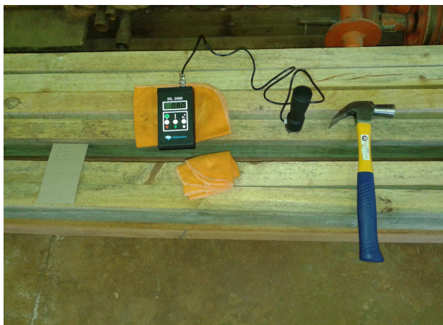
Fotografia 3: Determinação do teor de umidade por medidores elétricos Fonte: Autoria própria.
