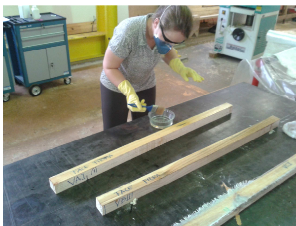
Fotografia 7: Aplicação da resina na superfície da madeira Fonte: Autoria própria.
