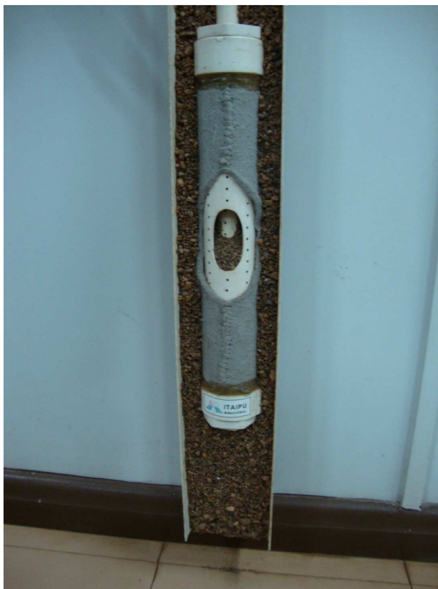
Figura 18 – Seção longitudinal da extremidade do piezômetro
