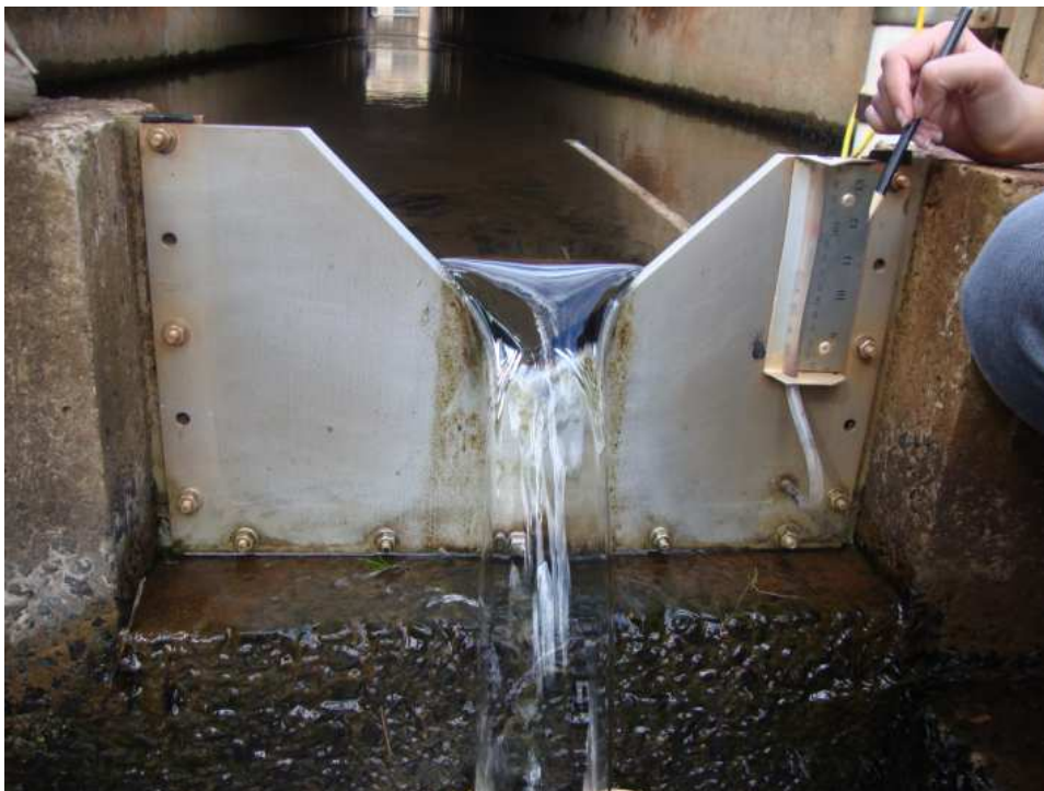
Figura 21 – Medidor de vazão triangular
