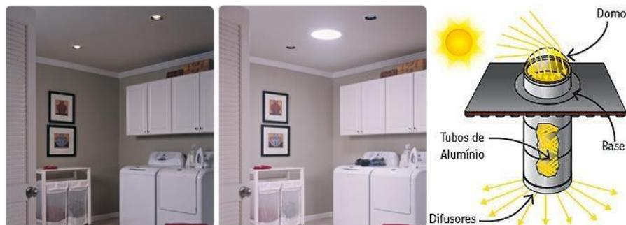
FIGURA: 10 Sistema de iluminação tubular
