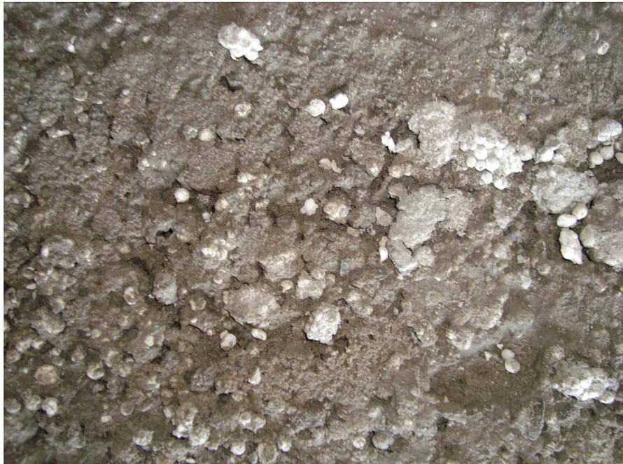
Figura 18 - Aspecto final do pano de concreto leve com adição de 60% de isopor
