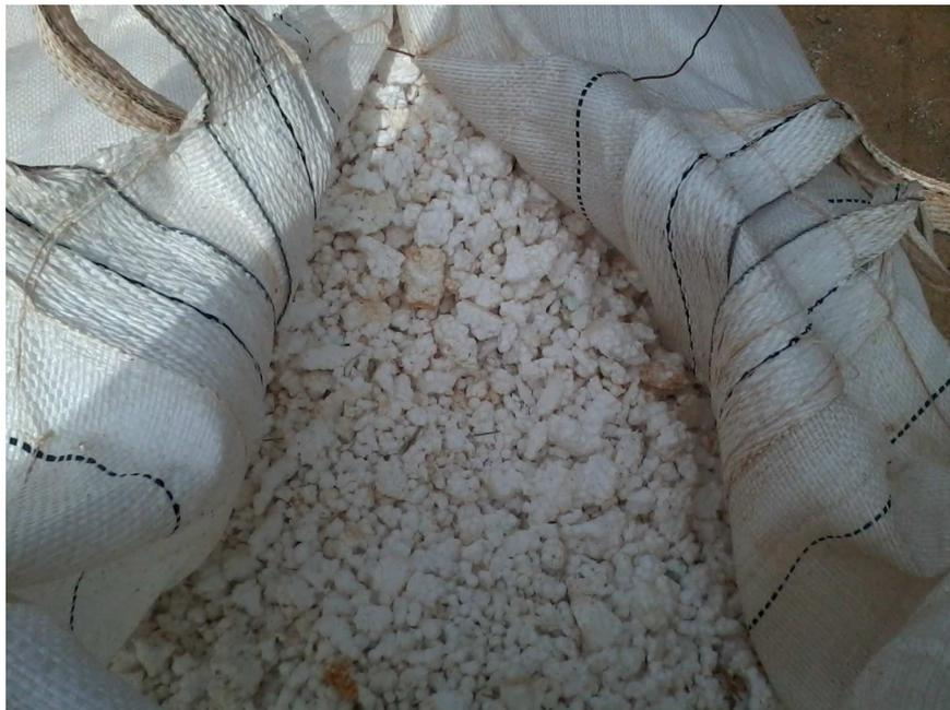
Figura 3 - Isopor após trituração
