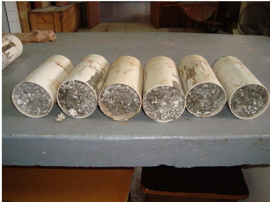
Figura 12 - Corpos de prova de concreto leve com adição de 60% de isopor
