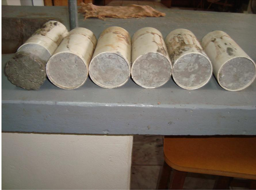
Figura 13 - Corpos de prova de concreto convencional
