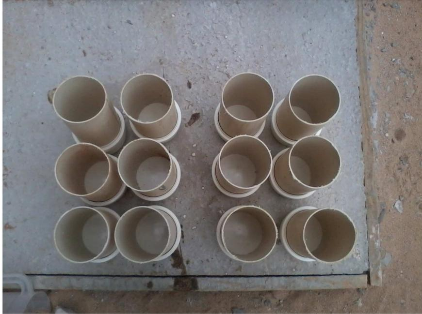
Figura 9 - Tubos de PVC selados com tampas de PVC
