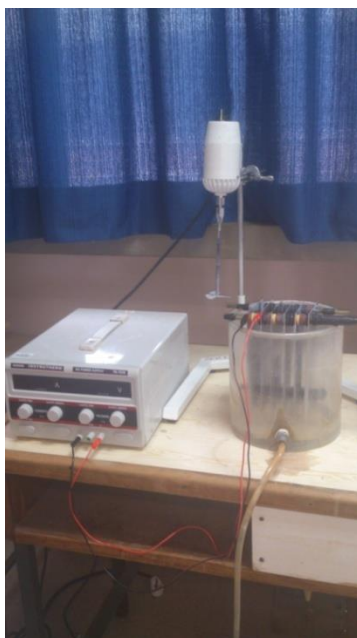
Figura 10 - Conjunto de equipamentos para tratamento por eletrocoagulação.
