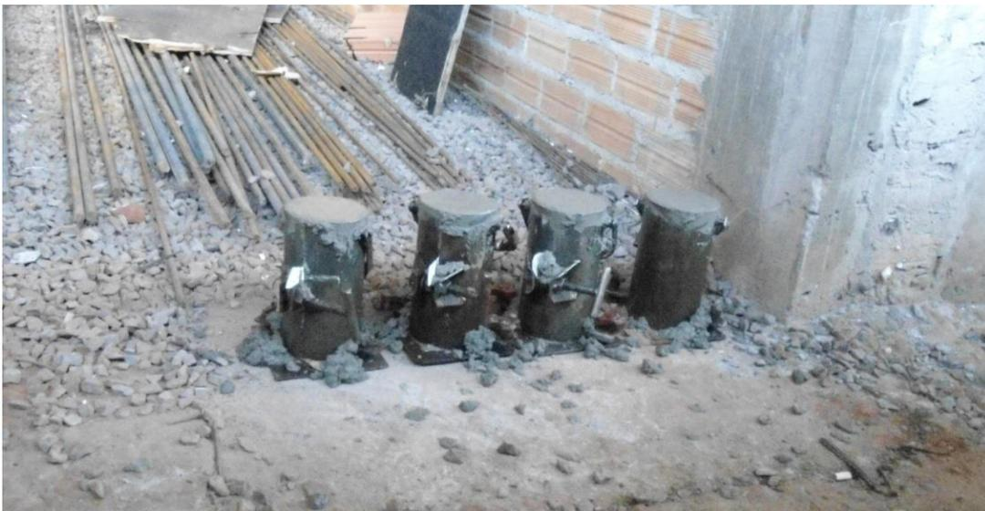
**Figura 21 – Corpos de prova do primeiro caminhão**
