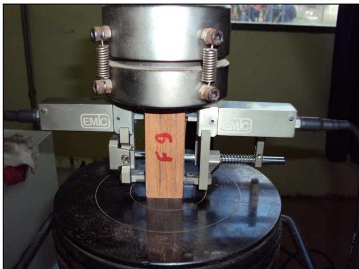
Figura 16 - Arranjo para o ensaio de compressão paralela às fibras
