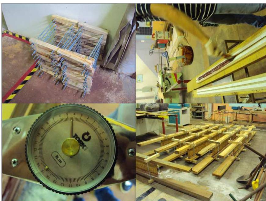
**Figura 21 - Colagem das vigas**
