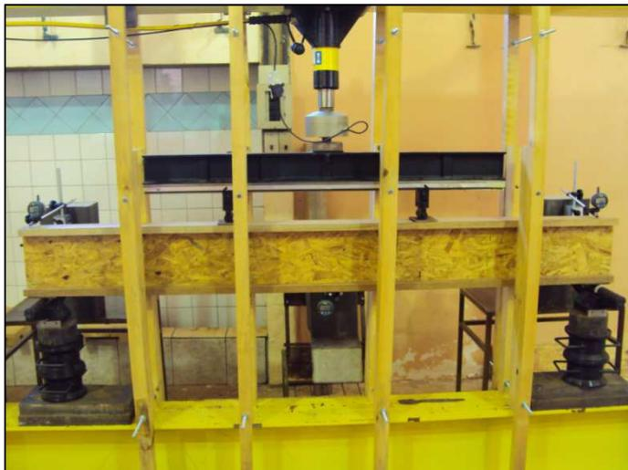
**Figura 23 - Arranjo para ensaio das vigas**
