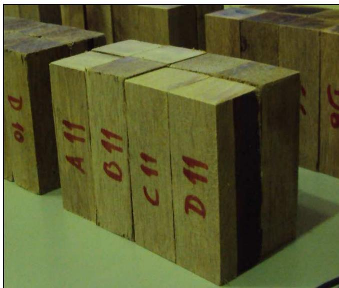
**Figura 15 - Corpos de prova para ensaio de compressão paralela às fibras**
