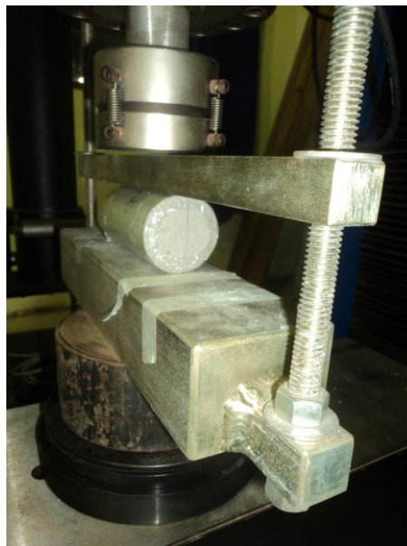
Figura 8 – Ensaio de tração por compressão diametral
