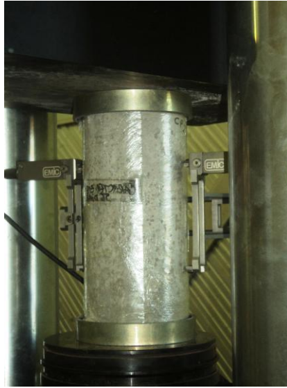
Figura 7 – Ensaio de resistência à compressão
