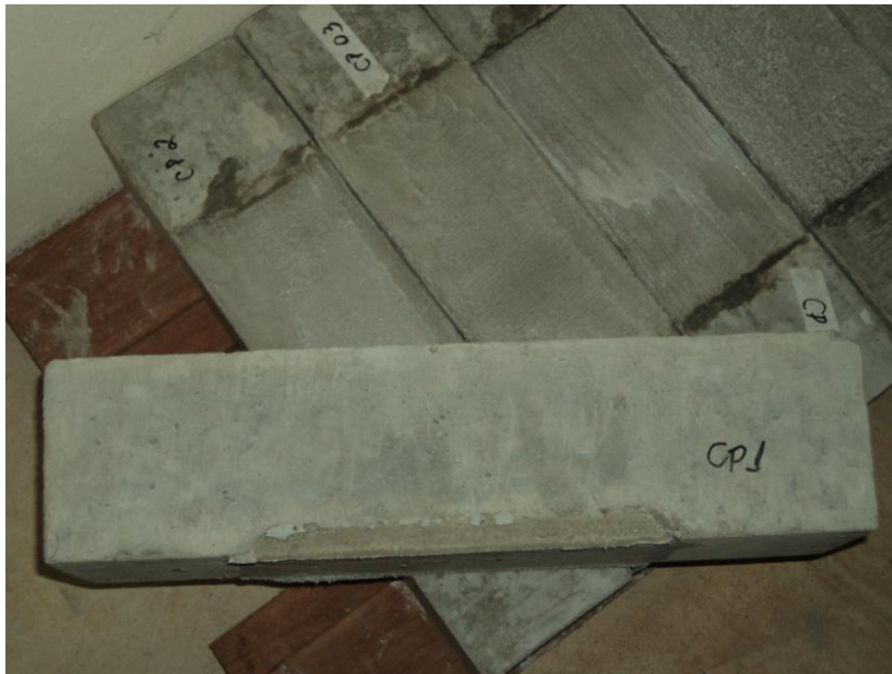
Figura 11 – Entalhes dos prismas preenchidos com argamassa de reparo
