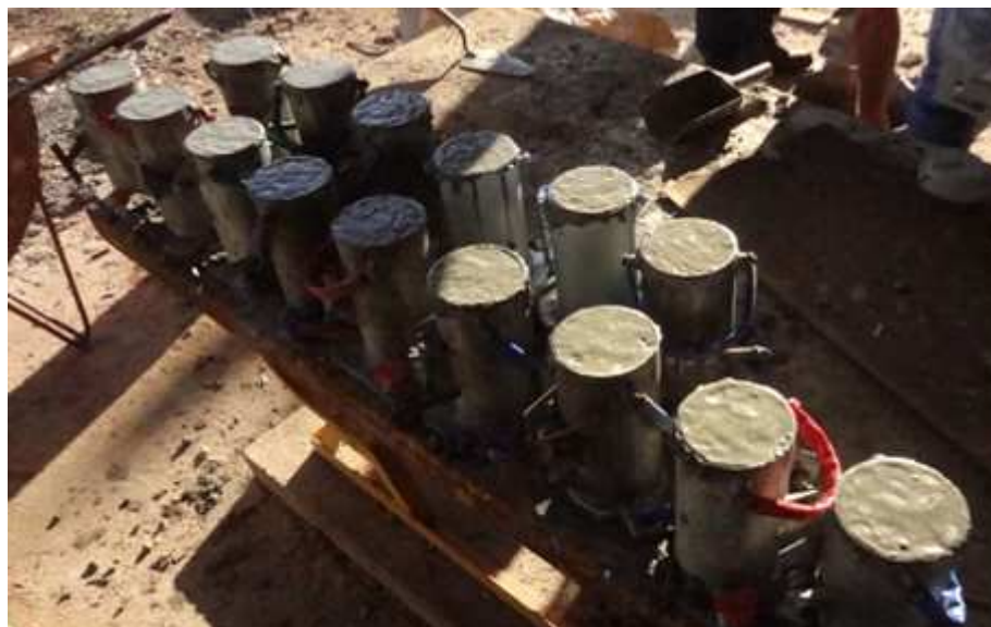
Figura 7 – Corpos de prova armazenados em local protegido por 24 horas.
