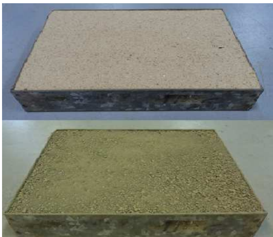
Figura 2 - Recipiente completo para determinação da massa específica aparente
