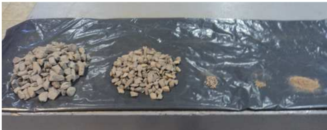
Figura 11 - Distribuição granulométrica da brita
