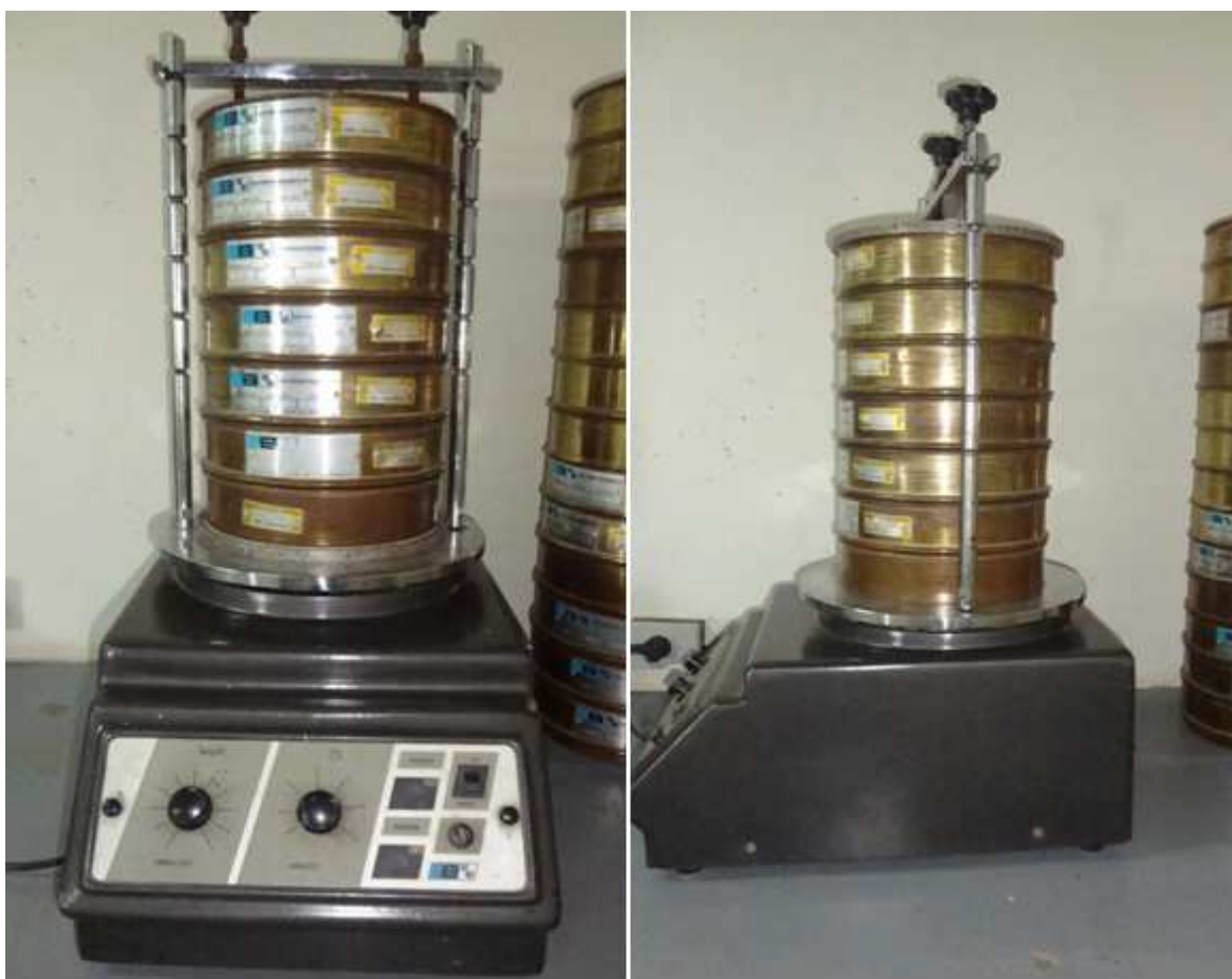
Figura 1 - Conjunto de peneiras e peneirador para ensaio de granulometria
