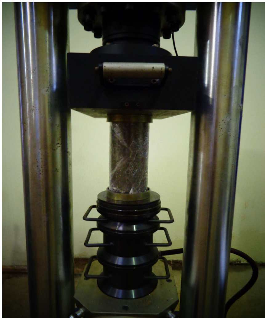
Figura 8 - Arranjo para teste de compressão axial
