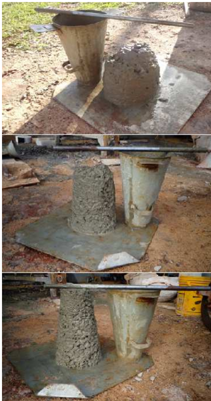
Figura 12 - Resultado do abatimento de tronco de cone
