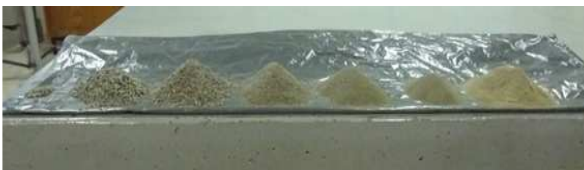
Figura 10 - Distribuição granulométrica da areia artificial
