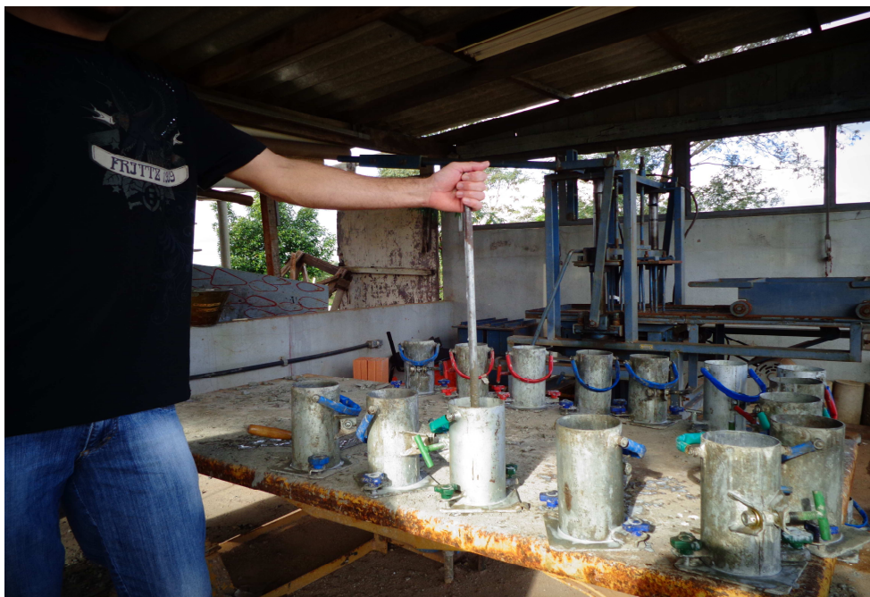
Figura 6 - Moldagem dos corpos de prova
