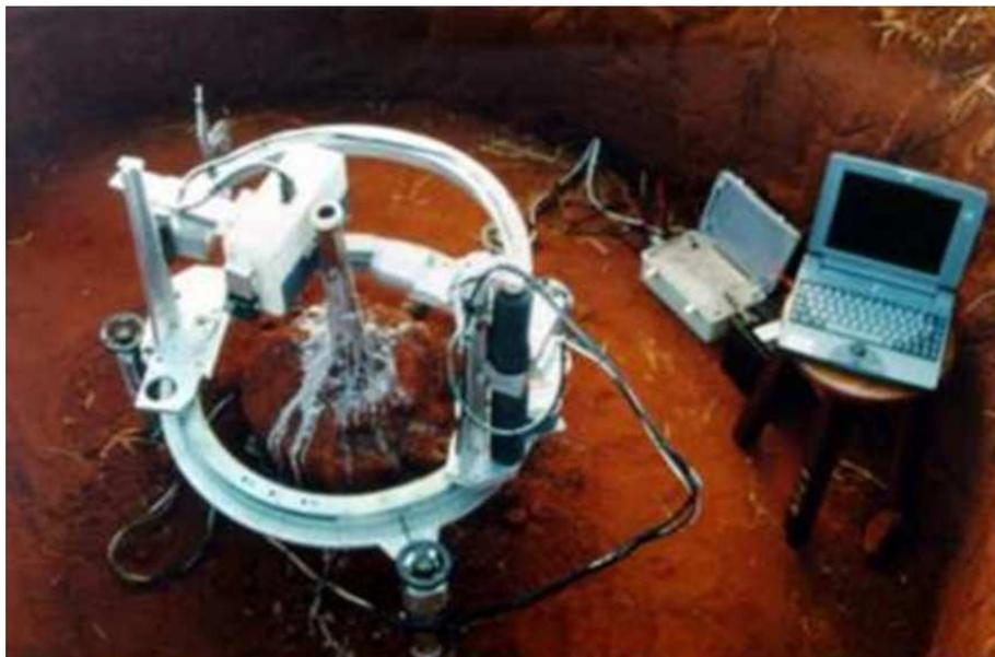
**Figura 7 – Tomógrafo portátil realizando a varredura tomográfica durante o processo de infiltração de água**
