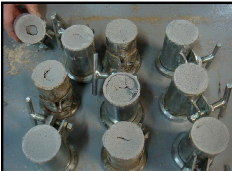
**Figura 12 - Retração apresentada pelos corpos de prova em cura da argamassa de assentamento não cimentícia**
