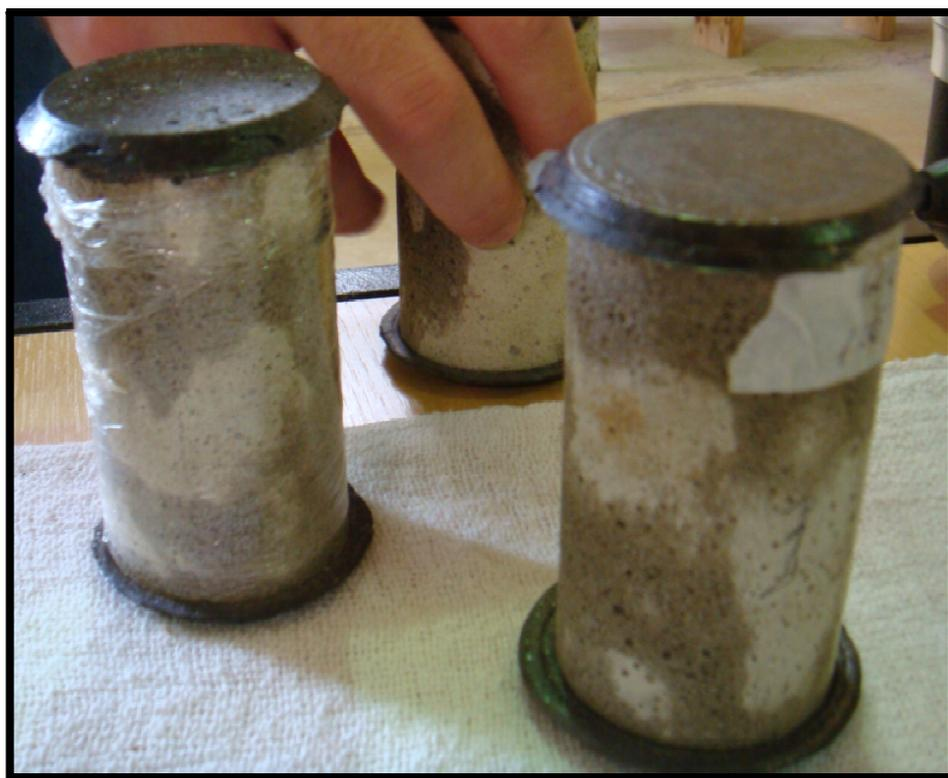
Figura 16 - Corpos de prova em idade de ruptura capeados com enxofre
