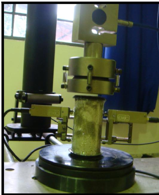
Figura 17 - Corpo-de-prova em preparação para ensaio de módulo de elasticidade
