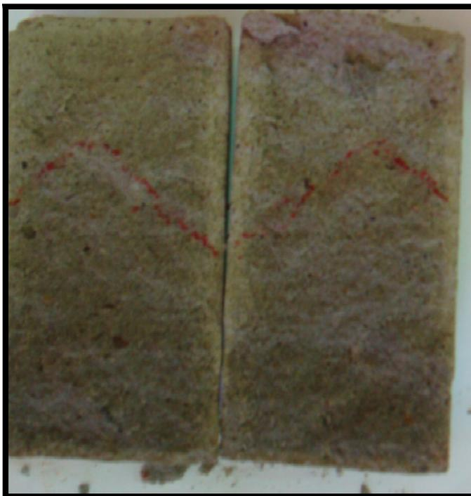
**Figura 21 - Detalhe do caminhamento da água no interior do corpo de prova de argamassa preparada "in loco" traço 1:5 e 200mL de aditivo por saco de cimento**
