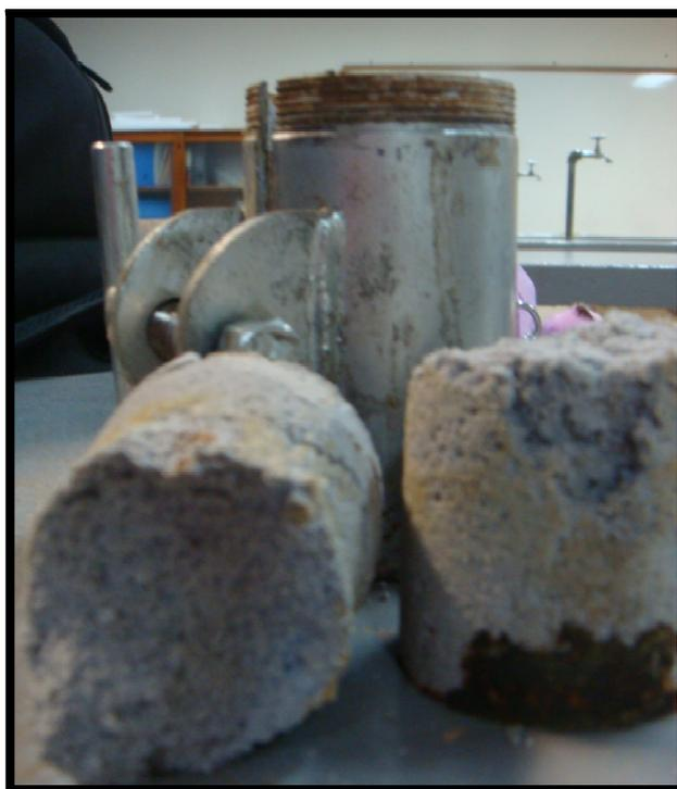
**Figura 15 - Corpo de prova de argamassa não cimentícia com 18 dias de idade apresentou consistência não rígida**
