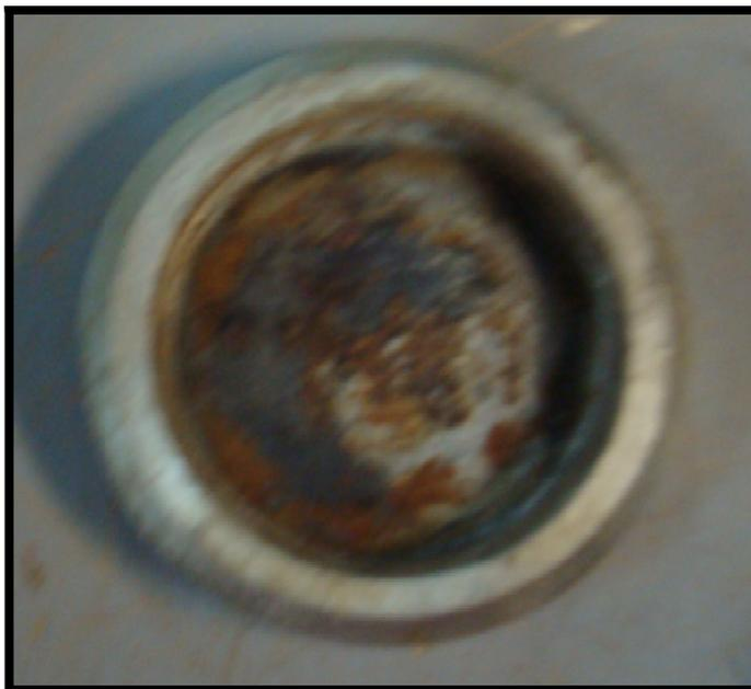
**Figura 14 - Detalhe do molde de corpo de prova que continha argamassa não cimentícia com sinais de oxidação**
