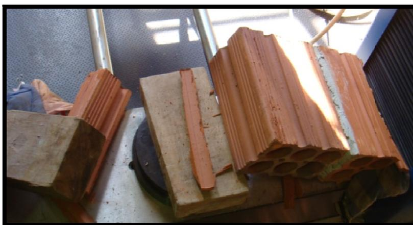
**Figura 26 - Modo de ruptura do prisma de bloco cerâmico assentado com argamassa industrializada**
