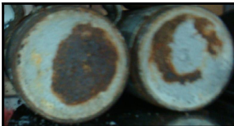
**Figura 13 - Corpo de prova de argamassa não cimentícia aderido fortemente ao molde e com sinais de oxidação**
