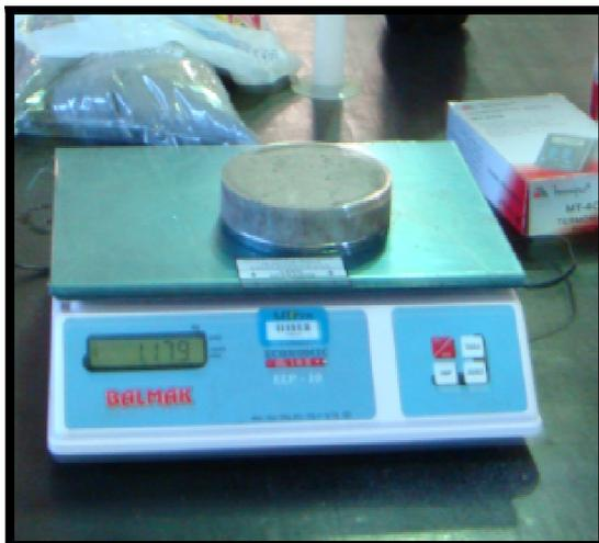
**Figura 10- Detalhe do ensaio de determinação de retenção de água**
