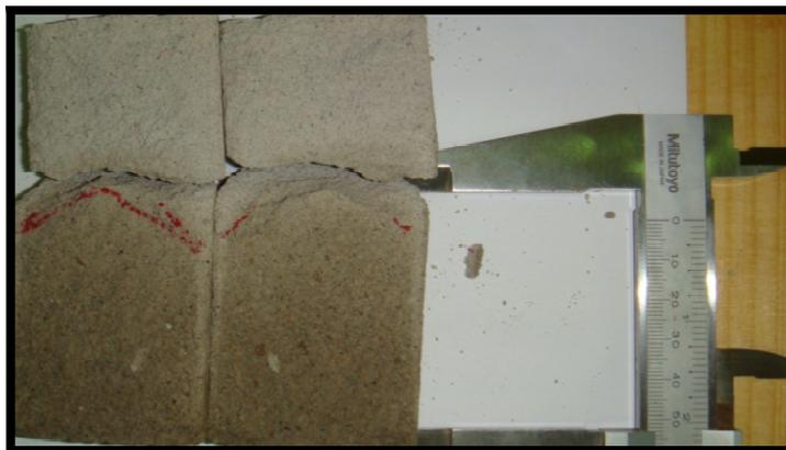
Figura 18- Detalhe do caminhamento da água dentro do corpo de prova de argamassa traço 1:6 e 200mL de aditivo por saco de cimento
