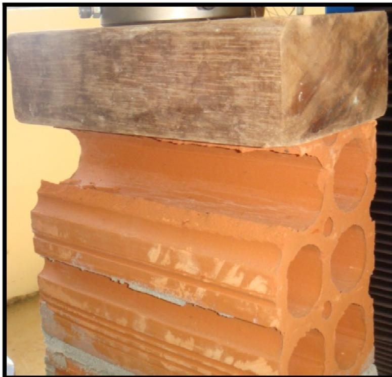
**Figura 27 - Modo de ruptura do prisma de alvenaria cerâmica assentado com argamassa não cimentícia**
