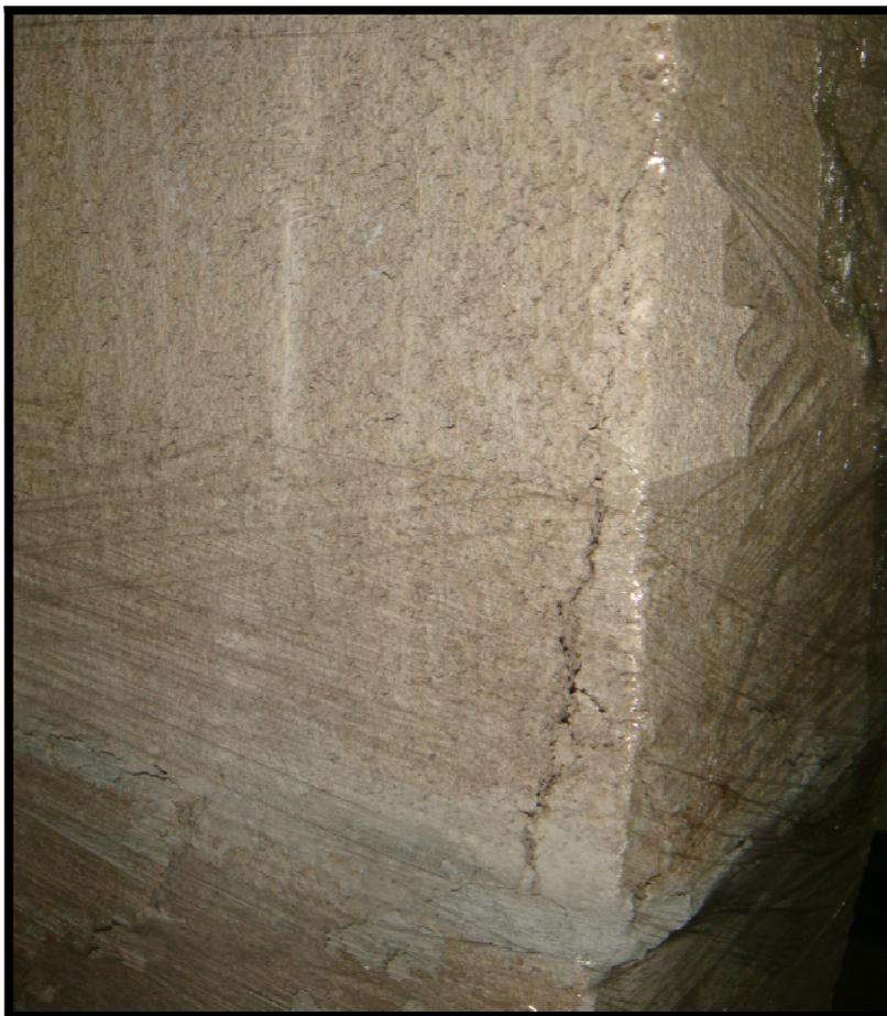
**Figura 25 - Caminhamento da fissuração por compressão do prisma oco de bloco estrutural assentado com argamassa industrializada própria para assentamento estrutural**
