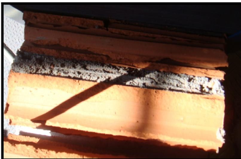
**Figura 28 - Modo de ruptura do prisma de bloco cerâmico assentado com argamassa preparada "in loco" traço 1:6**
