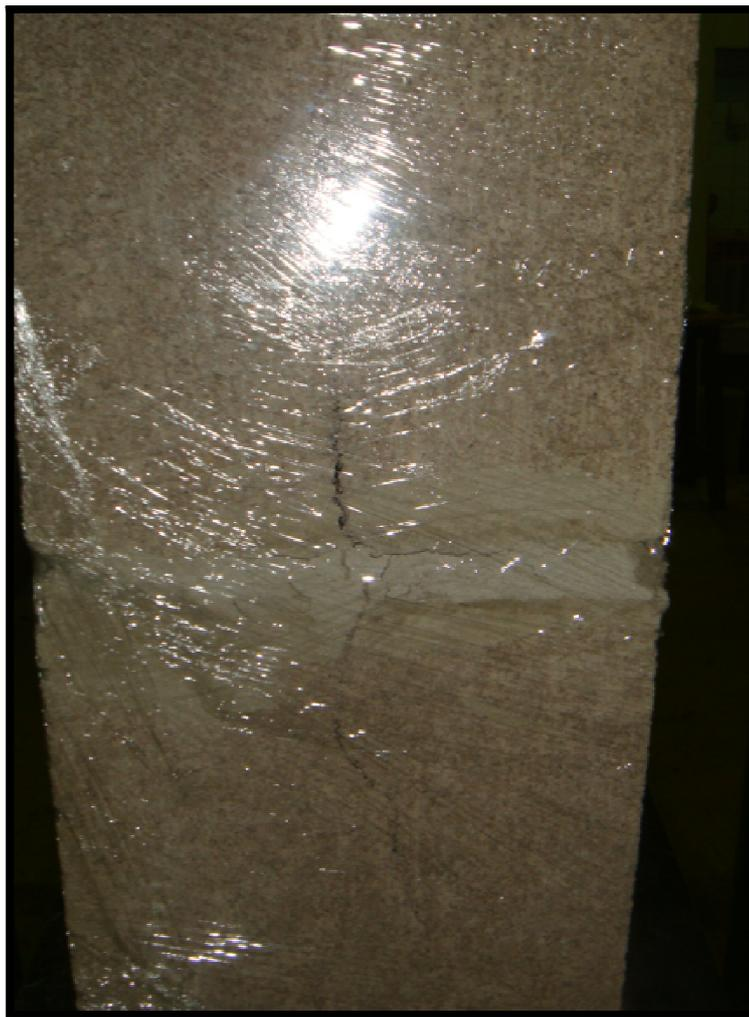
**Figura 24 - Caminhamento da fissuração por compressão do prisma oco de bloco estrutural assentado com argamassa industrializada para assentamento de alvenaria cerâmica**
