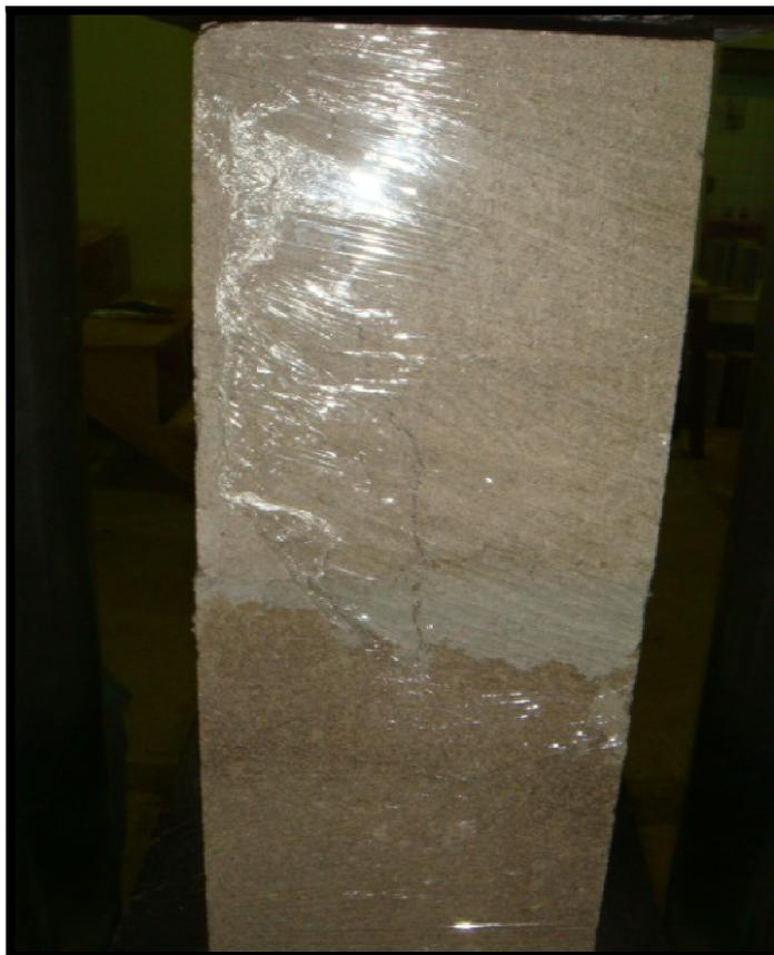
**Figura 23 - Caminhamento da fissuração por compressão do prisma oco de bloco estrutural assentado com argamassa traço 1:5**
