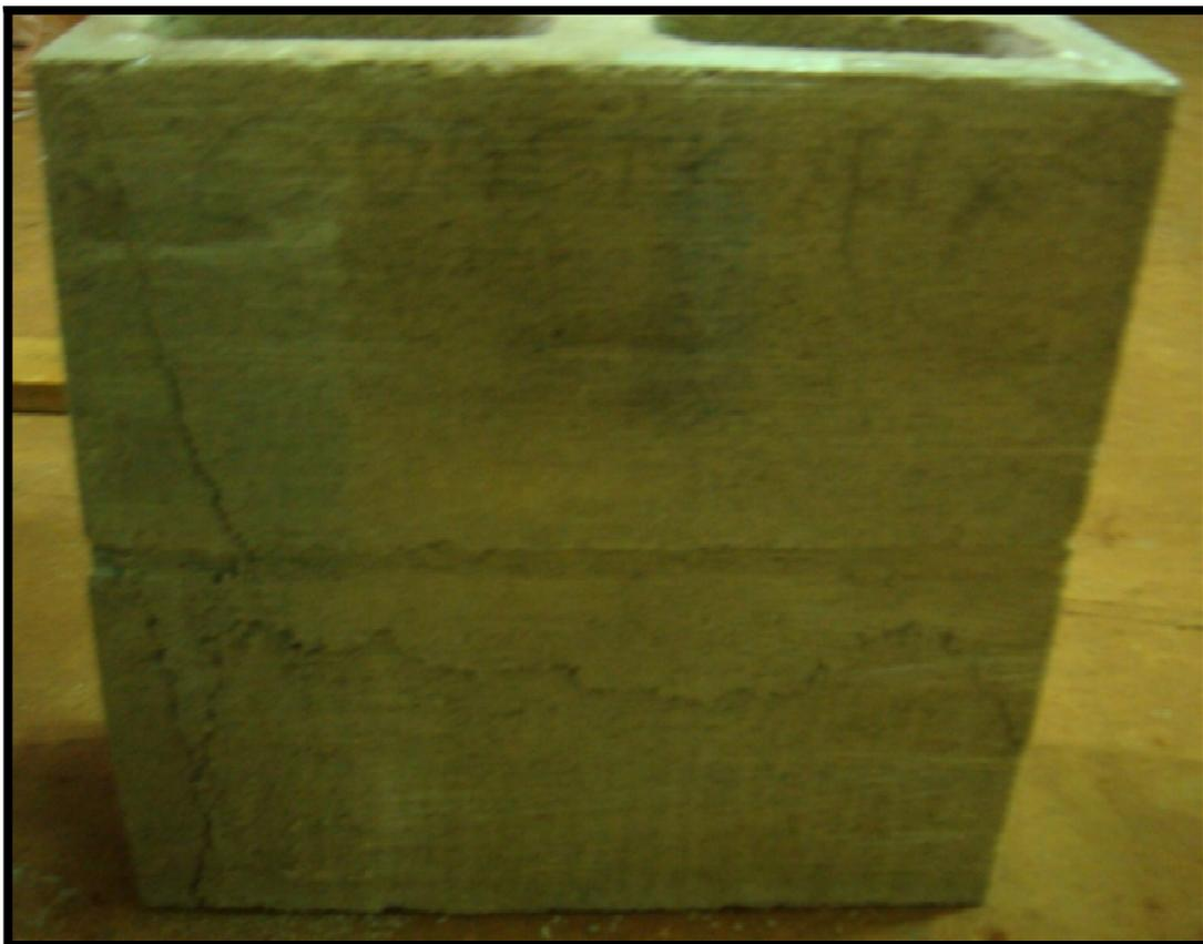
**Figura 22 - Caminhamento da fissuração por compressão do prisma oco de bloco estrutural assentado com argamassa não cimentícia**
