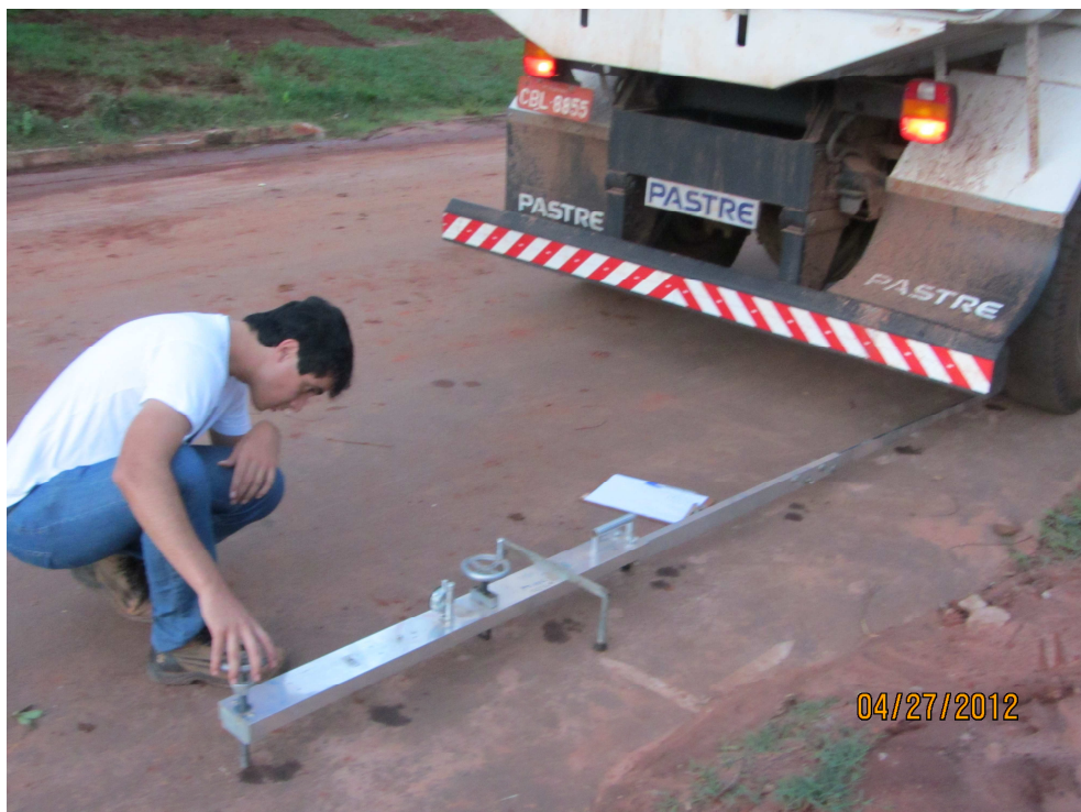
Figura 18 - Nivelamento da viga Benkelman
