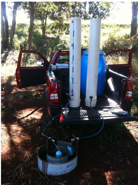
**Figura 7 - Conjunto de infiltrômetro com reservatórios adaptados.**
