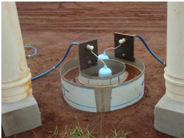
**Figura 8 - Detalhe das boias para manutenção do nível d'água nos anéis.**
