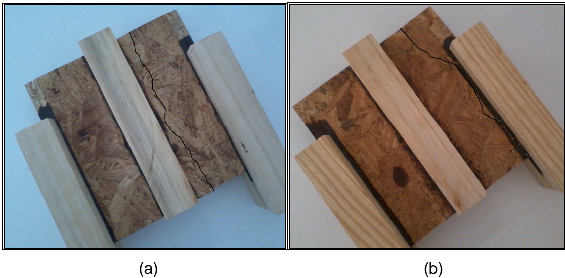
Figura 21. Ruptura dos corpos de prova, (21-a) ilustra a ruptura por cisalhamento na alma, (21-b) ilustra a ruptura na borda de ligação.
