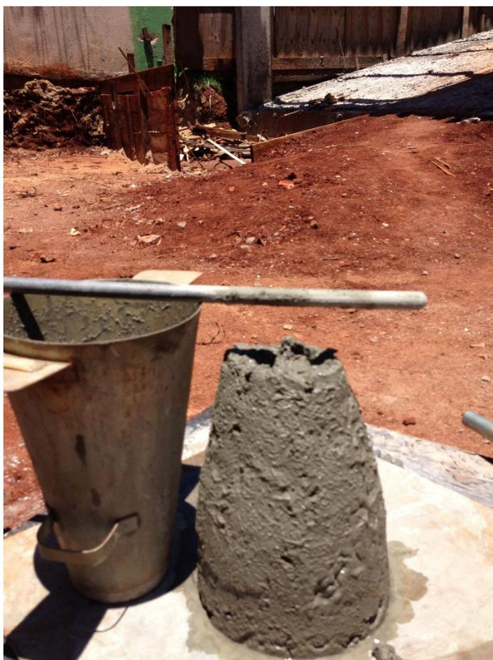
**Figura 6 – Teste de slump realizado in loco**
