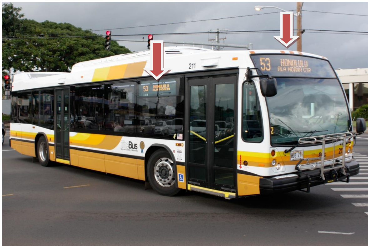
Figura 33 – Ônibus com painéis frontal e lateral de informação. Fonte: Wikimedia Commons (2011).
