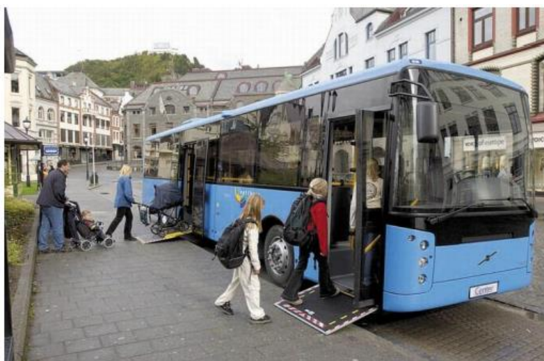
Figura 30 – Veículo de piso baixo com rampa. Fonte: Gabrilli (2014).
