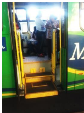
Figura 53 – ônibus de piso alto com plataforma elevatória
