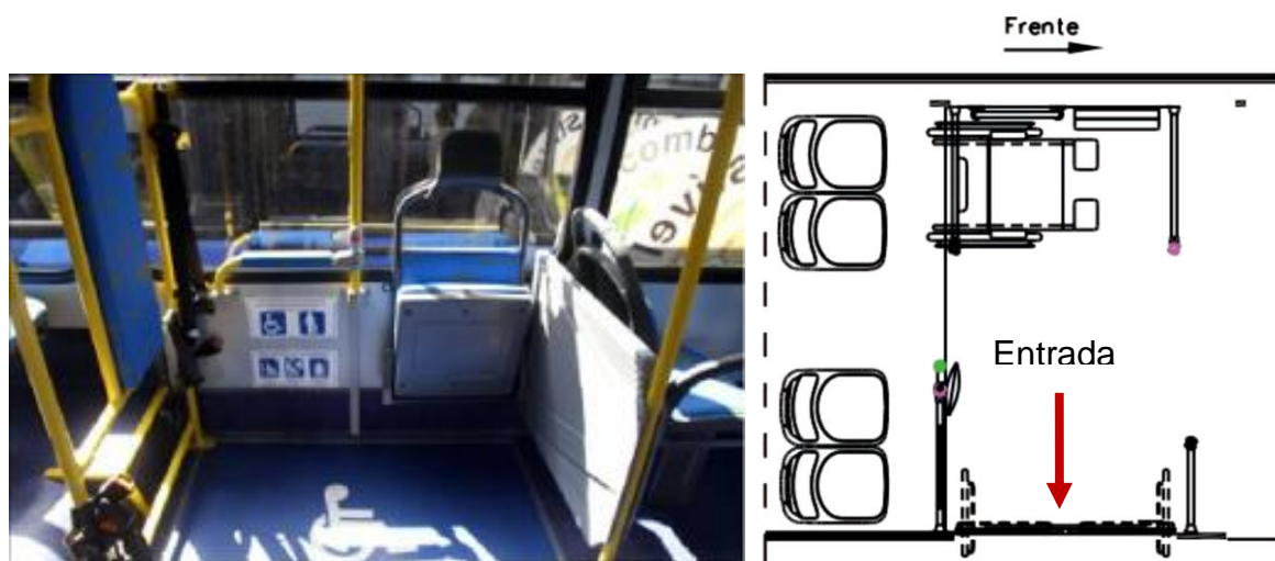
Figura 34 – Box reservado para cadeirantes, cão guia e carrinhos de bebê. Adaptado de: URBS (2014); ABNT NBR 14022 (2009).
