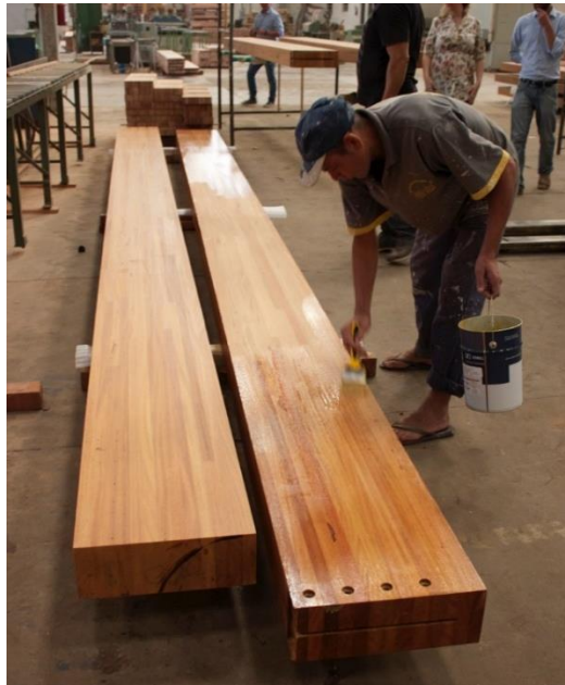
Figura 69 - Aplicação de verniz Fonte: Blog Estruturas de Madeira (2015)
