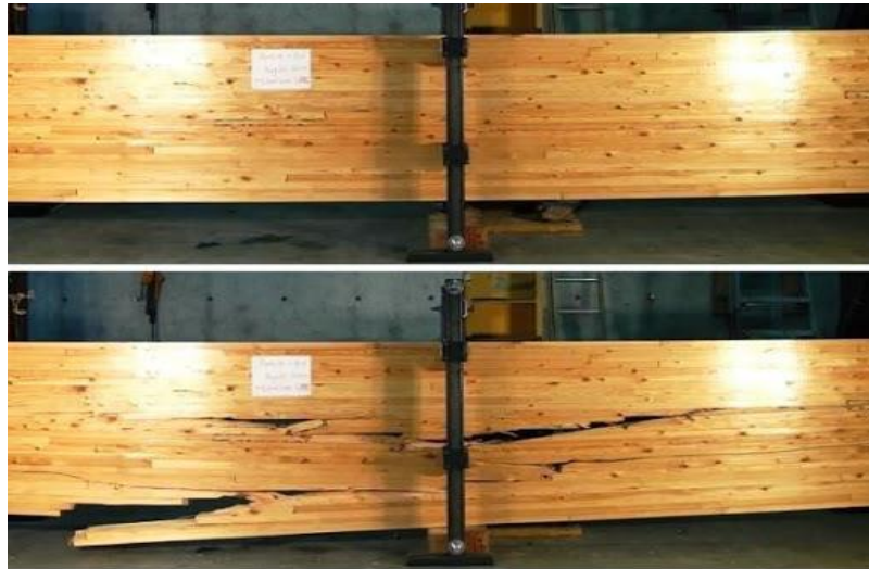
Figura 34 - Viga cisalhada após carregamento aplicado Fonte: Blog Estruturas de Madeira (2015)
