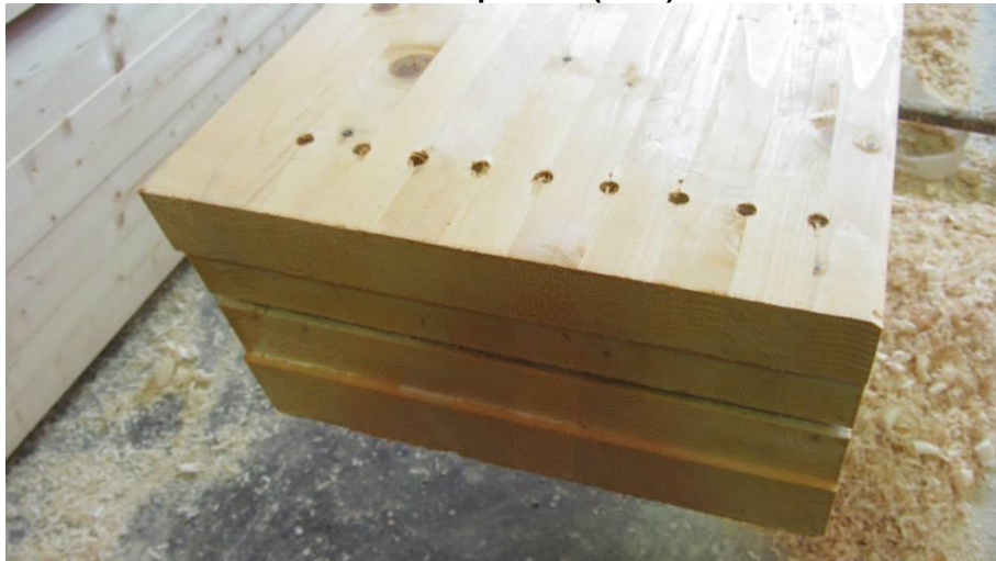
Figura 61 - Corte para encaixe de ferragens e pré-furos Fonte: Carpinteria (2014)
