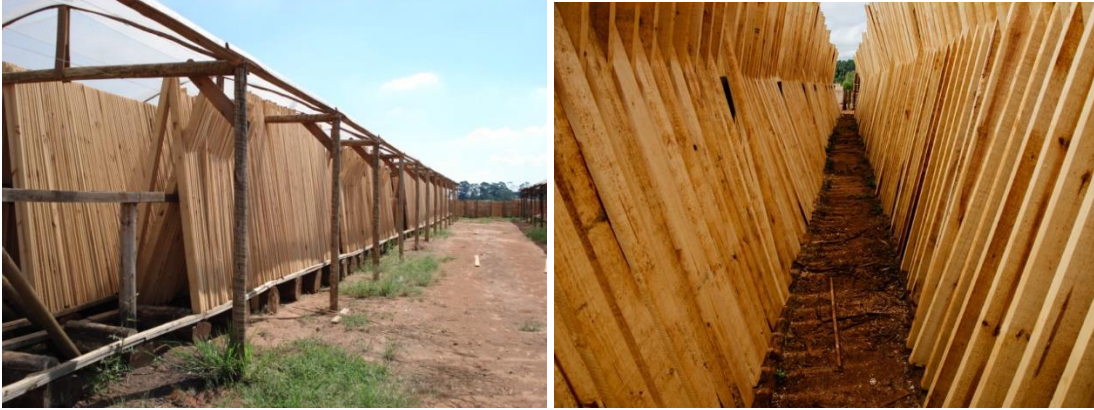
Figura 41 - Disposição das tabuas de madeira para secagem (varal) Fonte: http://www.duronmadeiras.com.br (2009)
