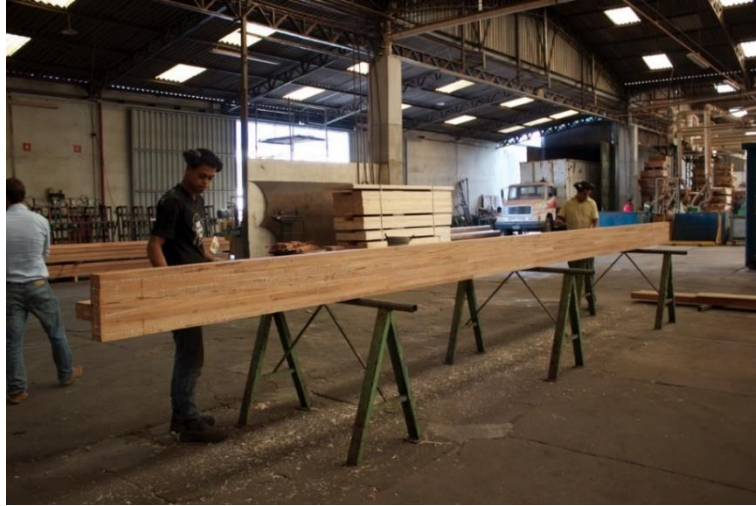
Figura 68 - Retirada do excesso da cola Fonte: Blog Estruturas de Madeira (2015)
