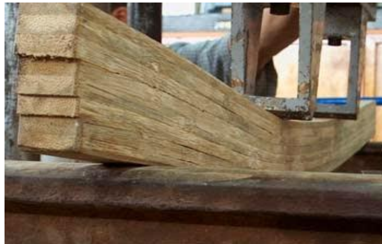
Figura 36 - Ensaio Cisalhamento de viga de MLC Fonte: Blog Estruturas de Madeira (2015)
