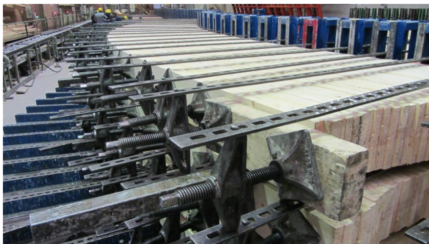
Figura 59 - Prensa de 48m para as vigas tipo "S" Fonte: Carpinteria (2014)
