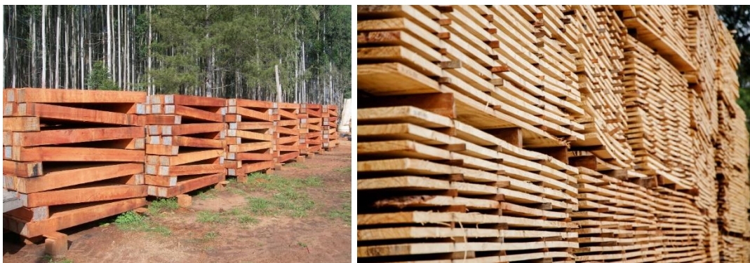
Figura 40 - Secagem natural da madeira em pilhas arejadas (tabique)
