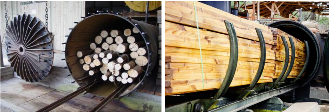
Figura 42 - Autoclave para tratamento de madeira Fonte: http://www.duronmadeiras.com.br (2009)
