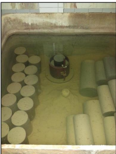
**Figura 12 – Molde Imerso para Saturação**
