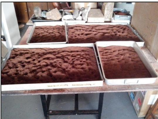
**Figura 6 – Secagem da Amostra ao Ar Livre**
