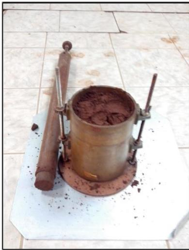
**Figura 10 – Compactação para Determinação do ISC**
