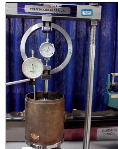
**Figura 13 – Penetração na Prensa Elétrica**
