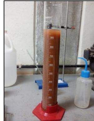
**Figura 16 – Granulometria por Sedimentação**
