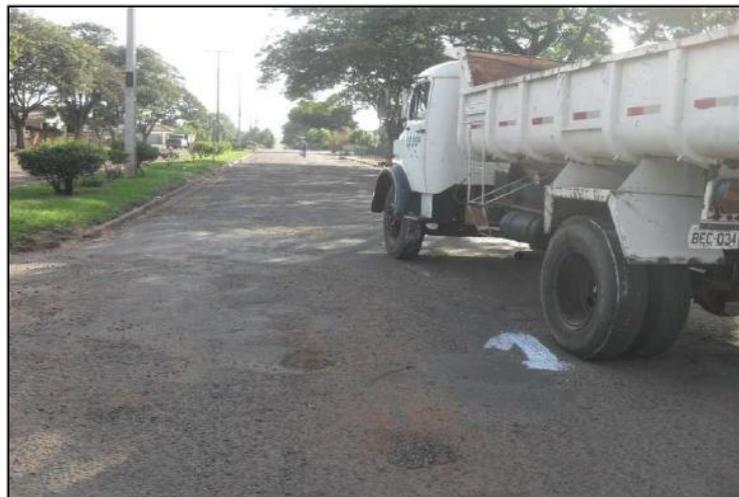
**Figura 19 – Caminhão Basculante no Ensaio da Viga Benkelman**
