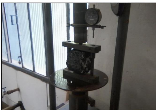
**Fotografia 9 – Rompimento dos Corpos-de-prova (Tração por Compressão Diametral)**
