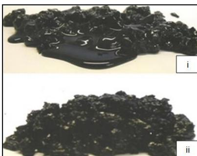
**Figura 2 – Exemplo de SMA formulado sem e com adição de aditivos estabilizadores**
