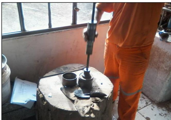
**Fotografia 5 – Compactação dos Corpos-de-prova**
