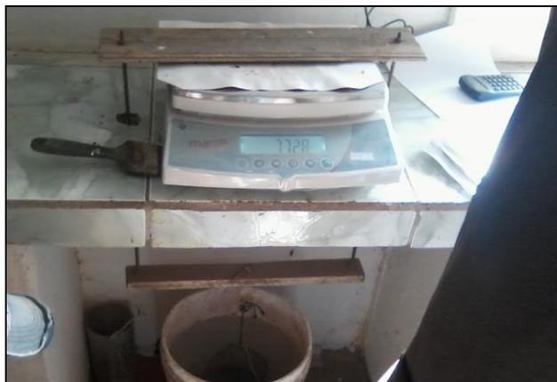
**Fotografia 2 – Pesagem da Amostra Imersa em Água**
