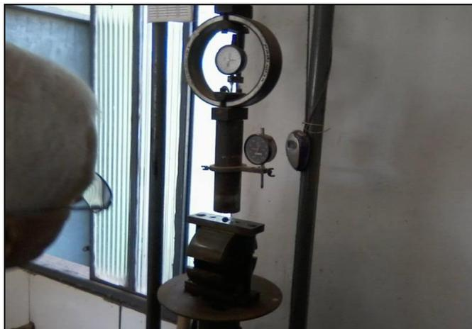
**Fotografia 8 – Determinação da Estabilidade e Fluência Marshall**
