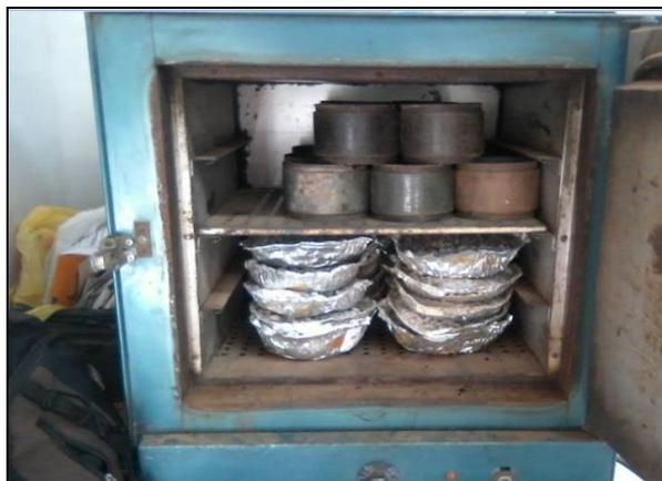
**Fotografia 3 – Misturas dos Agregados na Estufa**
