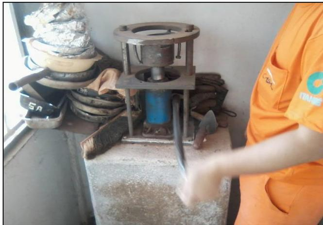
**Fotografia 6 – Retirada dos Corpos-de-prova dos Moldes**
