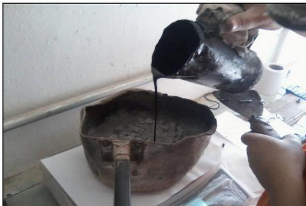
**Fotografia 4 – Processo de Mistura Manual do Ligante Asfáltico com os Agregados**
