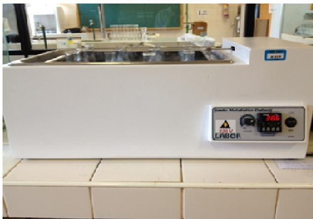
**Figura 7: Mesa agitadora de banho metabólico.**
