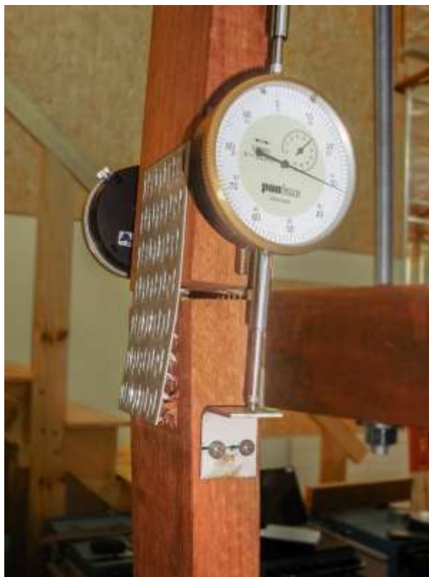
Figura 25 – Arrancamento da chapa ensaio de tração da ligação
