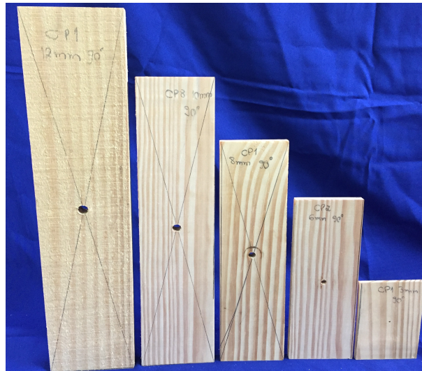
Figura 31 – Corpos de prova da espécie Pinus elliottii para ensaio na direção perpendicular às fibras
