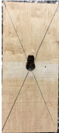
Figura 56 – Corpo de prova ensaiado da espécie Caixeta, na direção paralela às fibras e diâmetro de 15,80 mm (modo de falha 3)
