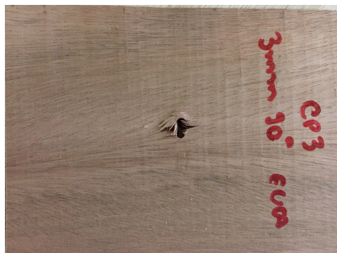
Figura 57 – Corpo de prova ensaiado da espécie Eucalipto-grandis, na direção perpendicular às fibras e diâmetro de 3,00 mm (modo de falha 3)
