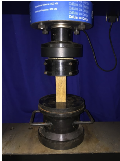
Figura 27 – Ensaio de compressão paralela às fibras
