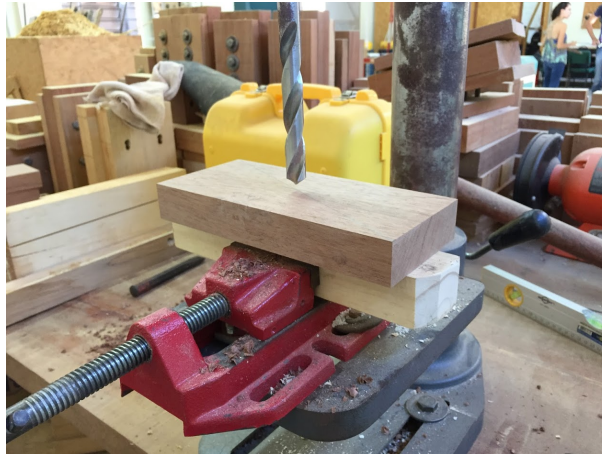
Figura 33 – Pré-furação dos corpos de prova
