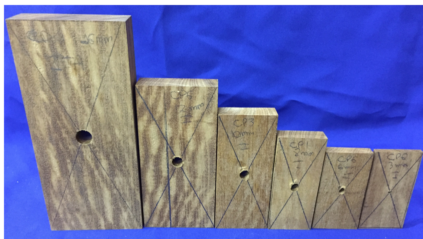
Figura 30 – Corpos de prova da espécie Itaúba para ensaio na direção paralela às fibras
