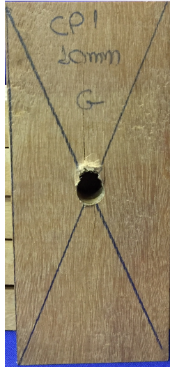
Figura 54 – Corpo de prova ensaiado da espécie Garapeira, na direção paralela às fibras e diâmetro de 9,70\text{ mm} (modo de falha 2)
