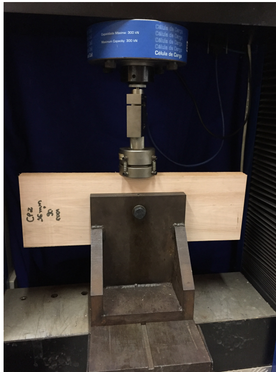
Figura 35 – Posição do aparato e corpo de prova para ensaio de embutimento na direção perpendicular às fibras
