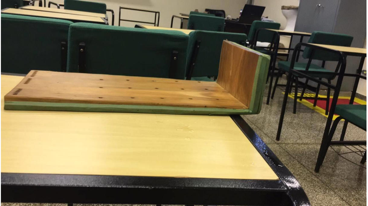
Figura 3 - Vertedor de paredes delgadas.
