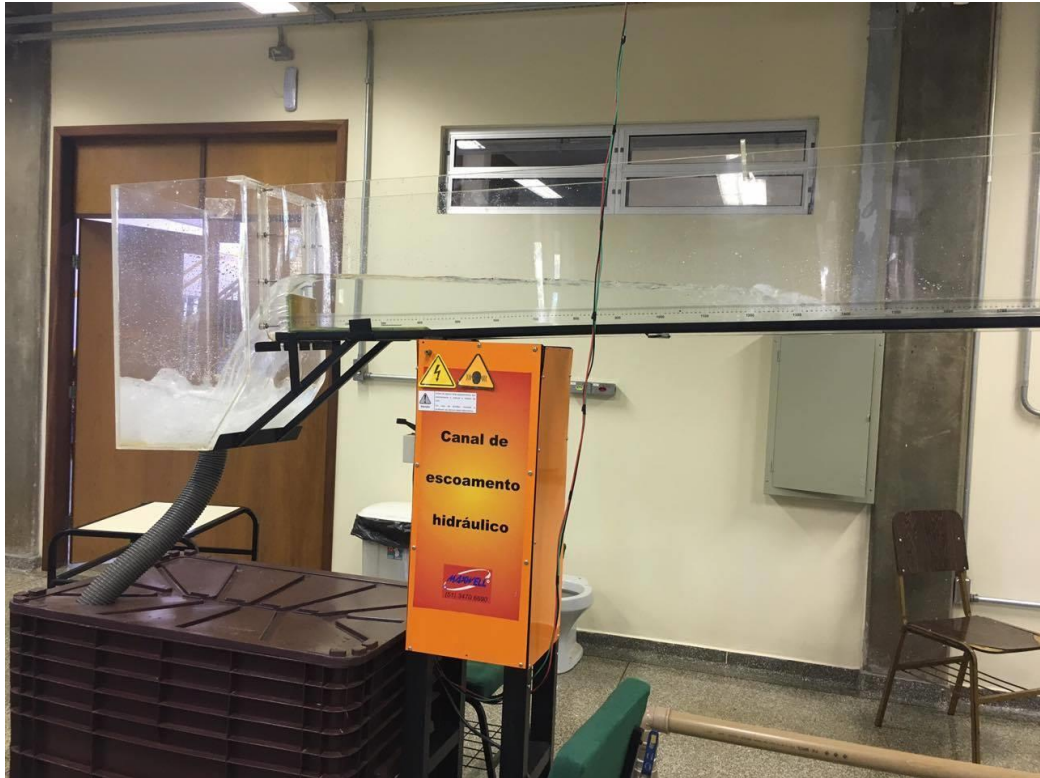
Figura 4 - Ressalto hidráulico ocorrendo no canal.
