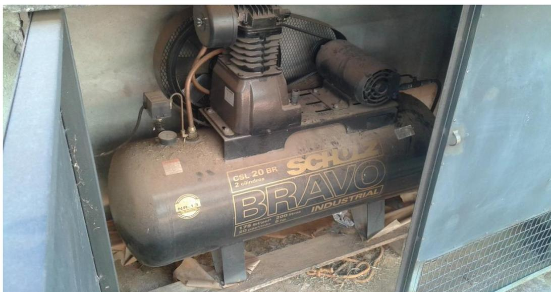
**Figura 20 – Compressor de ar, capacidade 200 litros.**
