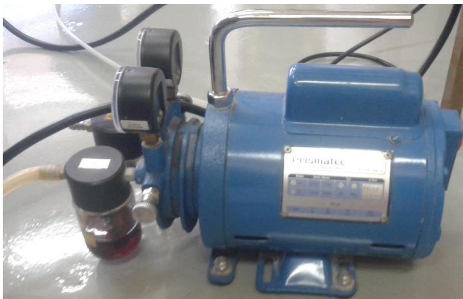
**Figura 21 – Bomba de vácuo.**
