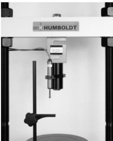
Figura 10 – Configuração de instalação para o ensaio Marshall.
