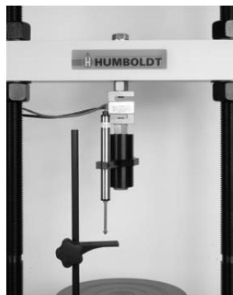
Figura 13 – Configuração de instalação para o ensaio triaxial UU.
