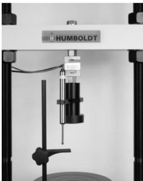
Figura 12 – Configuração de instalação para o ensaio de compressão simples.
