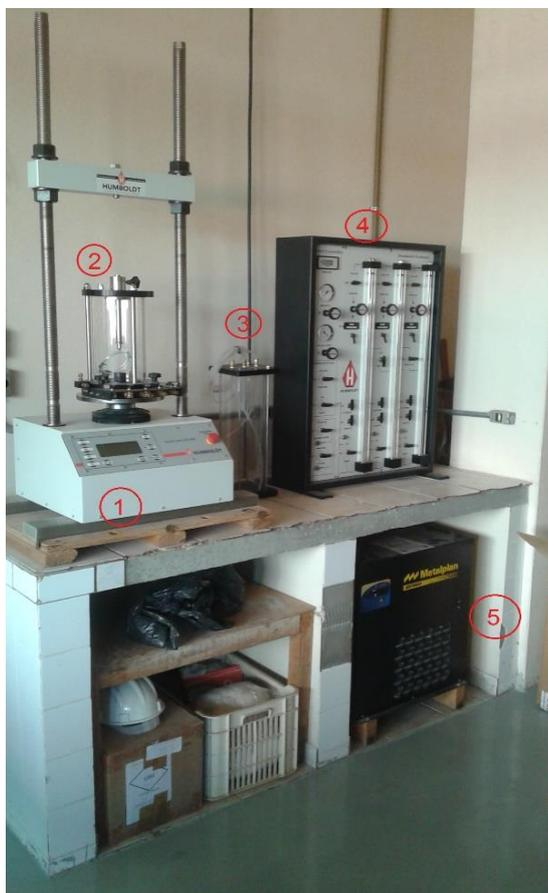
**Figura 19 – Equipamento para ensaio de compressão triaxial.
