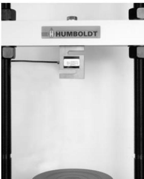
**Figura 14 – Configuração para ensaio TSR/Solo Cimento.**
