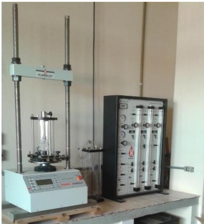
**Figura 9 – Equipamento de ensaios de compressão triaxial-Humboldt.**
