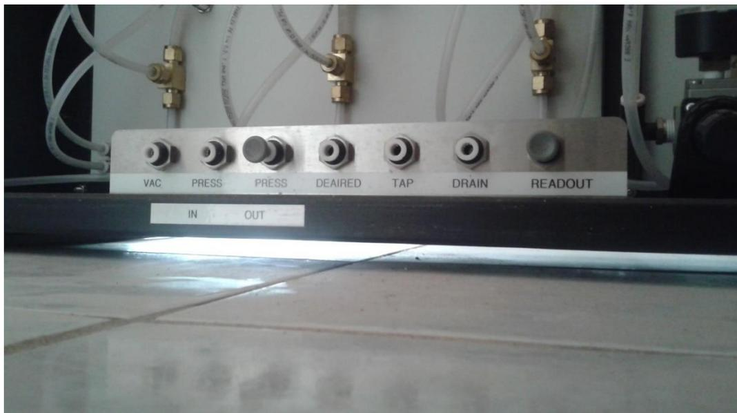
Figura 23 – Vista das conexões no *FlexPanel*.
