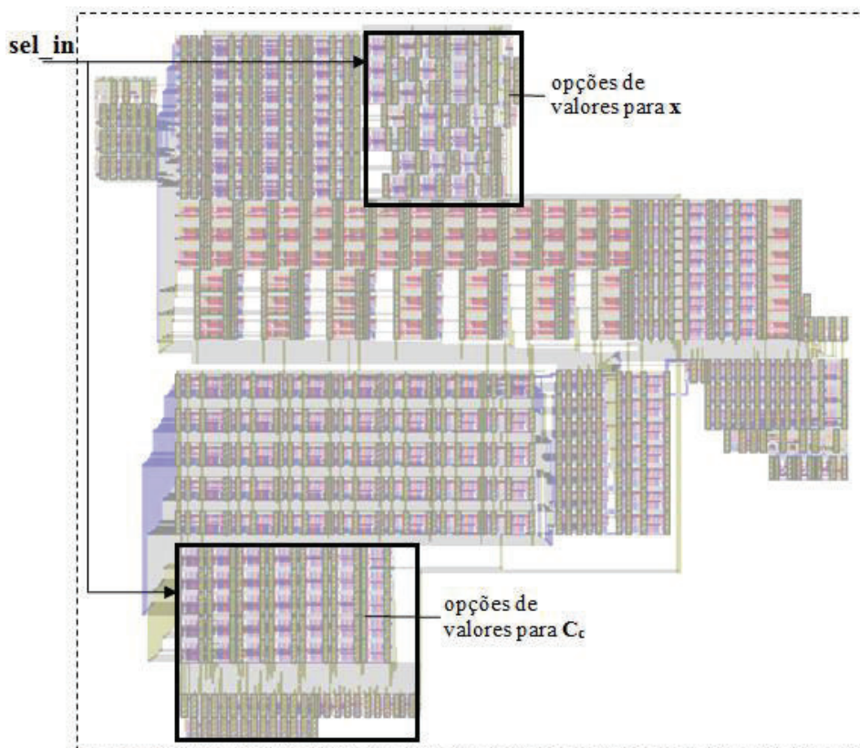
Figura 7.32 - Layout do bloco de seleção de palavra-código vencedora com os circuitos adicionais de entrada/saída,
