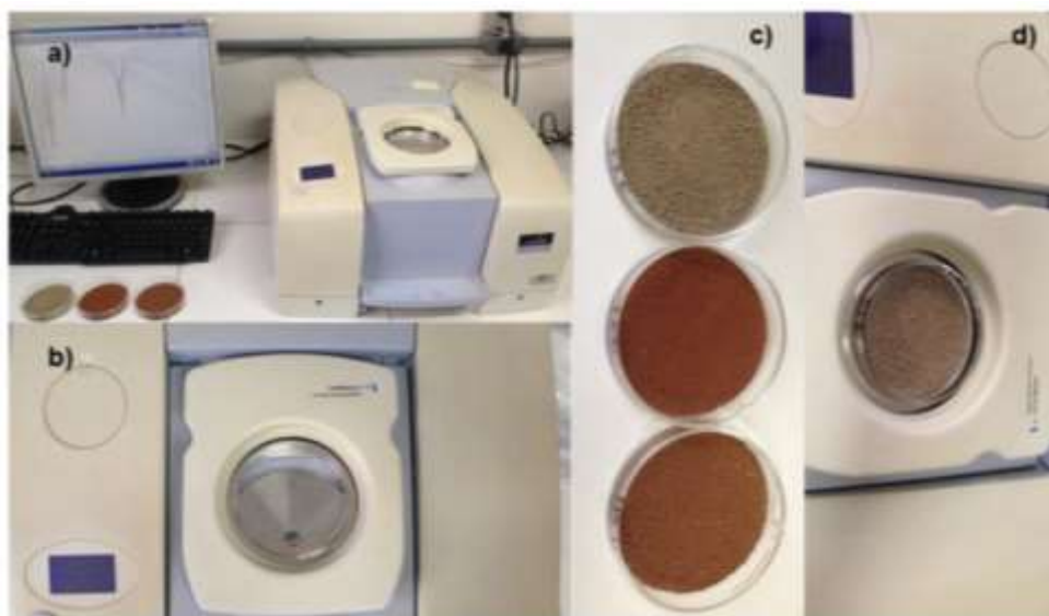
Figura 1 - a) Equipamento NIR (Spectrum 100N, PerkinElmer) empregado na aquisição dos espectros das amostras de solo; b) saída do feixe de radiação infravermelha do acessório de reflectância difusa (NIRA); c) placas de vidro de 90mm de diâmetro empregadas como amostradores; e) amostras no acessório de reflectância difusa.
