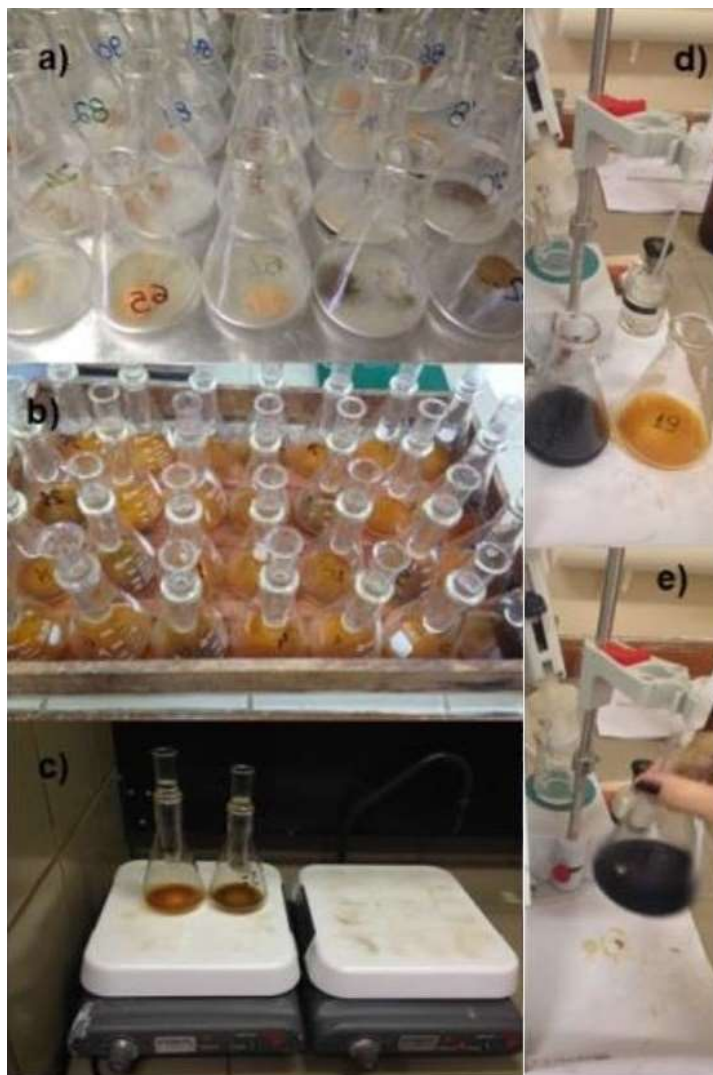
Figura 2 - Etapas principais do método da oxidação com dicromato de potássio empregado como referência nas análises de carbono orgânico no solo: a) pesagem das amostras de solo; b) digestão das amostras com solução de dicromato de potássio; c) digestão a quente; d) adição do indicador difenilamina; e) titulação do excesso de dicromato com solução de sulfato ferroso amoniacal.
