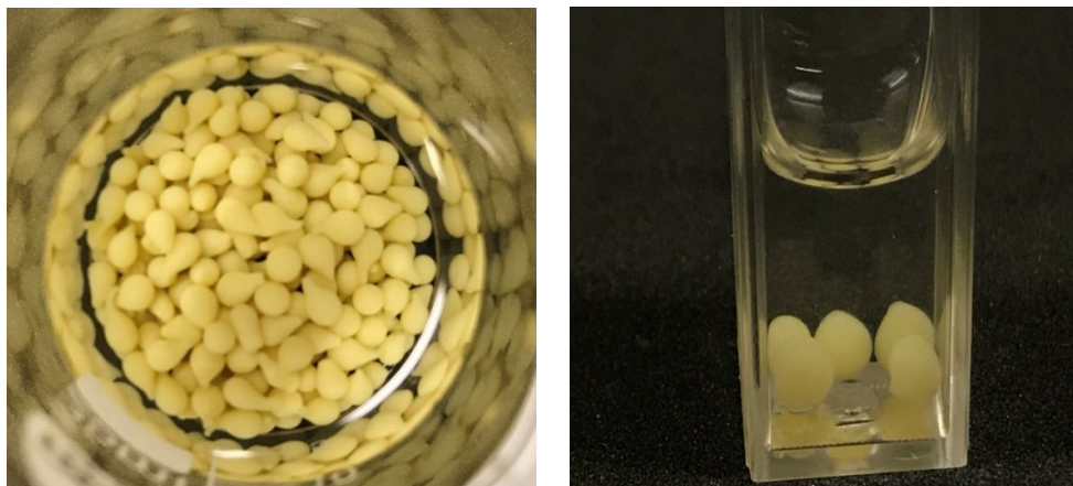
Figura 13 - Esferas de quitosana em solução aquosa de glutaraldeído 6% e extrato enzimático.
