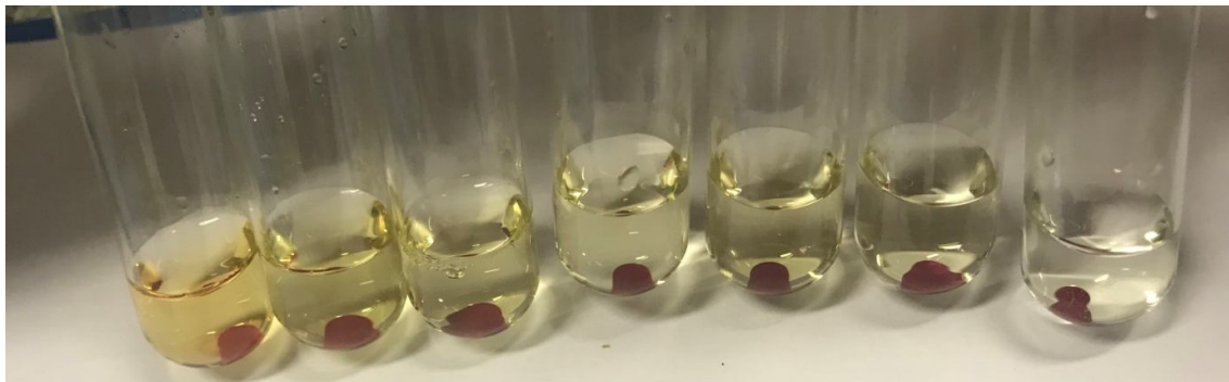
Figura 29 - Análise das esferas com as soluções de Cloreto de acetilcolina nas concentrações de 100, 50, 10, 5, 1 e 0,5 mmol/L, e água respectivamente.
