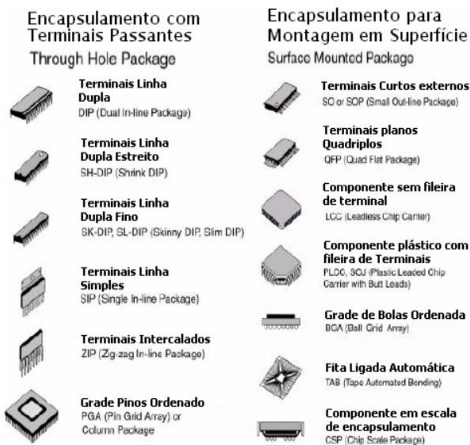
Figura 14: Tipos de encapsulamentos de componentes eletrônicos
