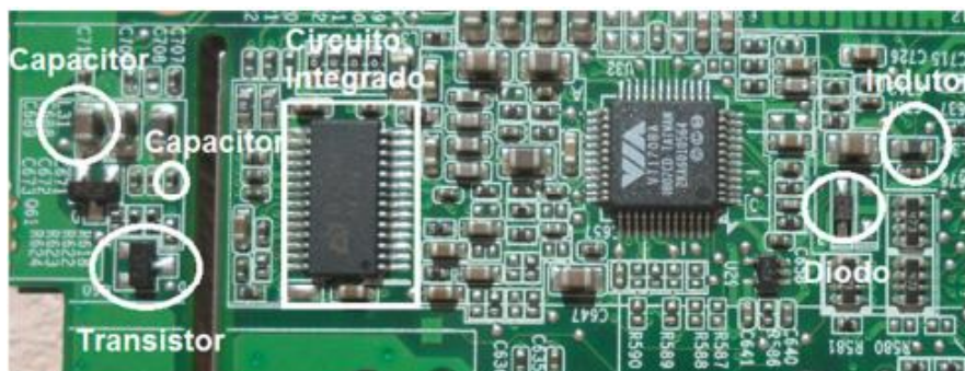
Figura 17: Exemplos de componentes SMDs e suas respectivas nomenclaturas
