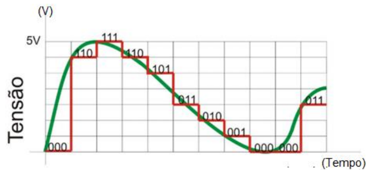
Figura 4: Sinal de saída de um sensor digital.
