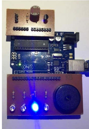
Figura 55: Indicador da saída de acionamento do ventilador ligado.
