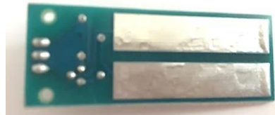
Figura 29: Sensor de umidade de solo P23, verso.
