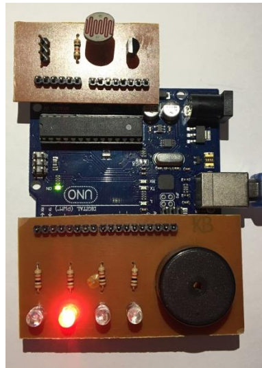
Figura 56: Indicador da saída de acionamento do aquecedor ligado.
