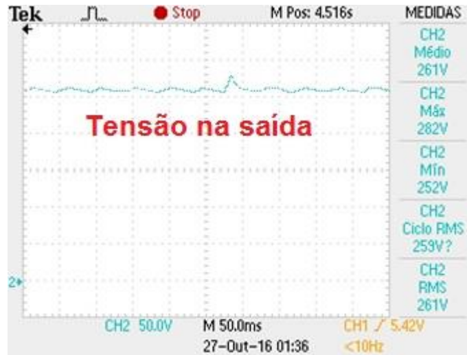
Figura 58 – Resposta do conversor a saída de carga a degrau
