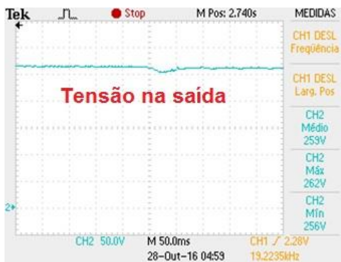
Figura 57 – Resposta do conversor a entrada de carga a degrau
