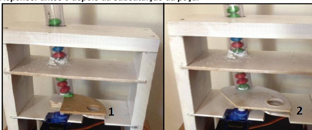
Legenda: 1: Peça com  $90^\circ$  e 2: Peça com  $145^\circ$ .
