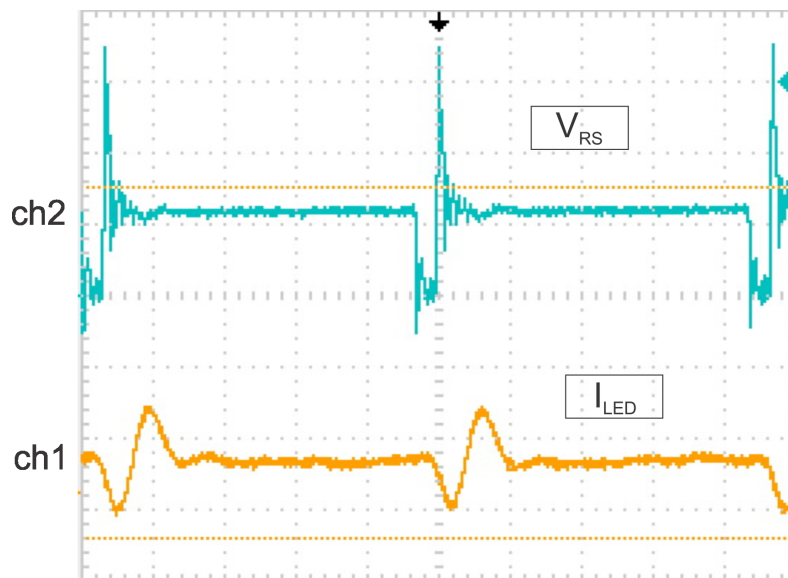
Figura 50: Tensão no resistor shunt (Ch 2) e corrente na carga (ch1) quando aplicado 55 V na entrada do Buck. Base de tempo: 2,50 \mu\text{s}/\text{div} , Ch1: 0,50 A/div e Ch2: 1,00 V/div.
