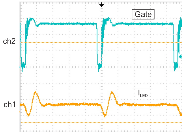
Figura 49: Largura de pulso (Ch 2) e corrente na carga (ch1) quando aplicado 55 V na entrada do Buck. Base de tempo: 2,50 \mu\text{s}/\text{div} , Ch1: 0,50 A/div e Ch2: 5,00 V/div.
