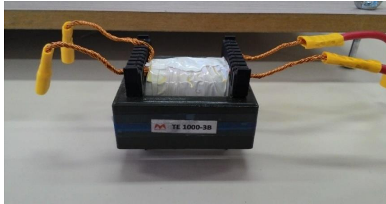
Figura 45 – Transformador de isolamento do protótipo.
