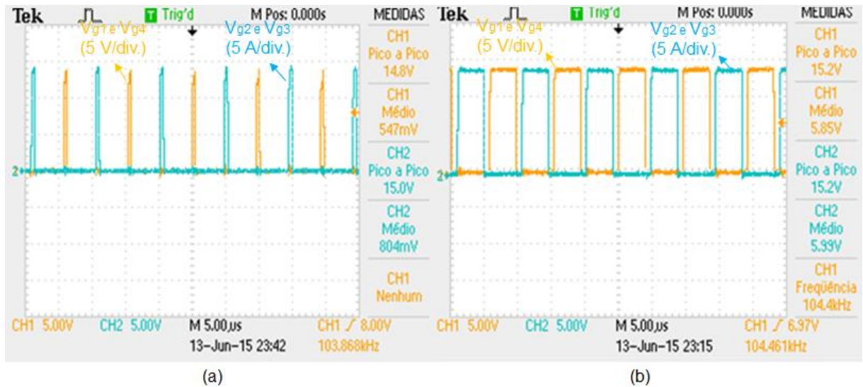
Figura 39 – Razão cíclica máxima e mínima do conversor, a) – Razão cíclica mínima, no qual o canal 1 apresenta o sinal de acionamento do IGBT_1 e do IGBT_4 e o canal 2 o sinal de acionamento do IGBT_2 e IGBT_3 e b) Razão cíclica máxima, onde o canal 1 apresenta o sinal de acionamento do IGBT_1 e do IGBT_4 e o canal 2 o sinal de acionamento do IGBT_2 e IGBT_3.
