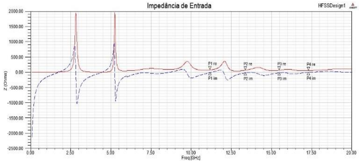
Figura 11 – Impedância de Entrada da Antena Fractal.
