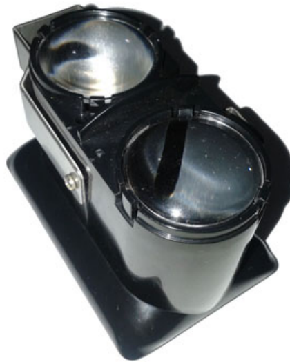
Figura 25: Encapsulamento das Lentes Plano-Convexa do Emissor e Receptor
