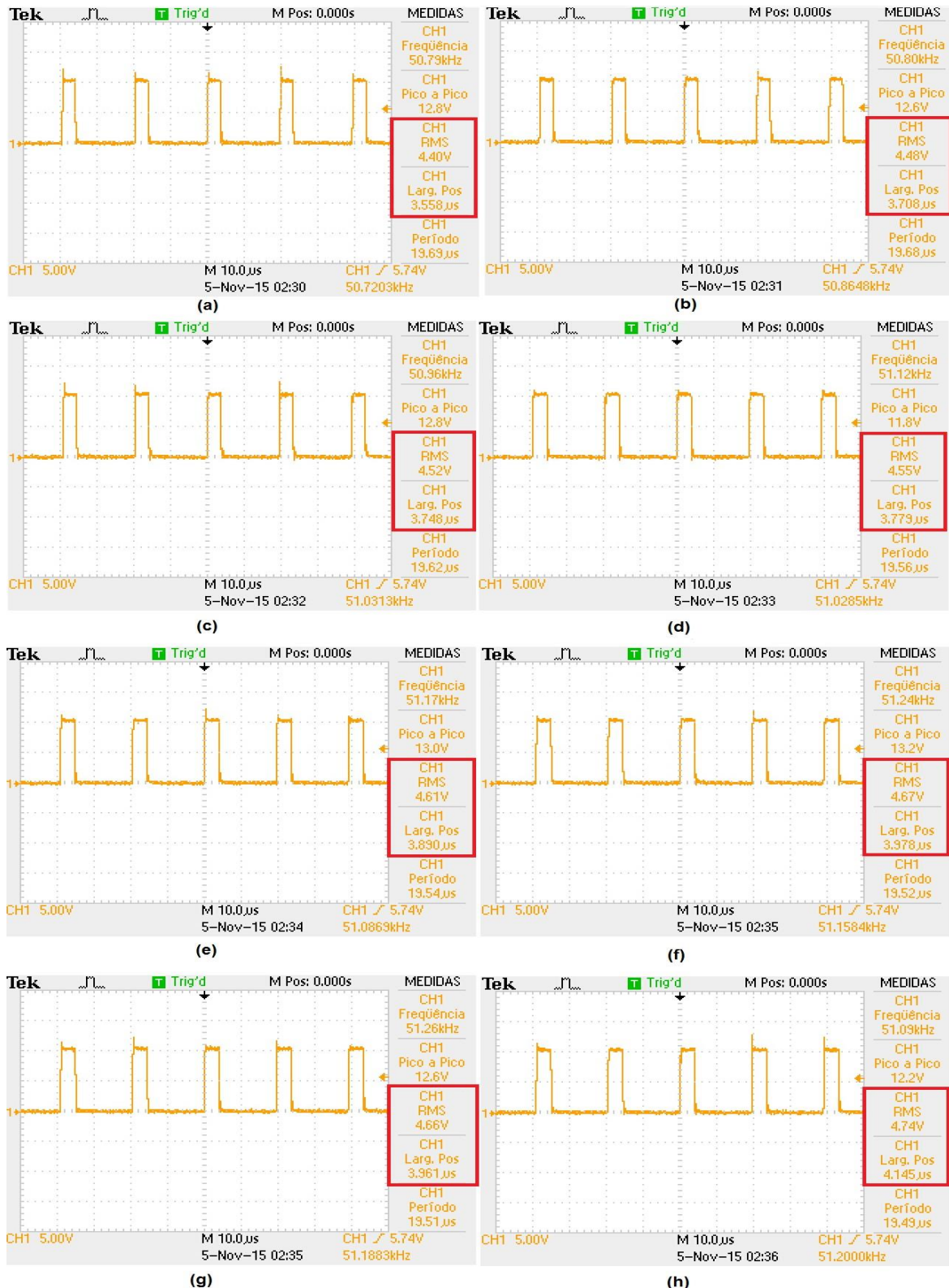
Figura 36 – Sinal do controle PWM com 127 V CA na entrada do retificador e vários níveis de corrente
