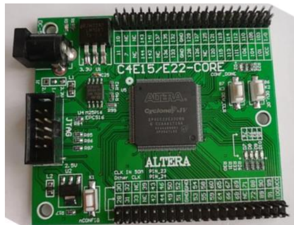
Figura 13 - Placa FPGA utilizada.
