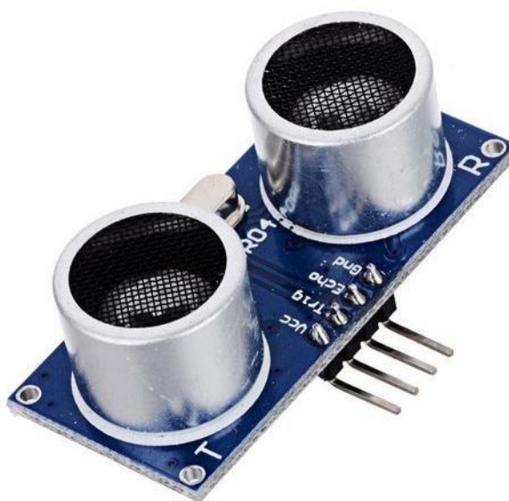
Figura 4 - Sensor ultrassônico com emissor e receptor.
