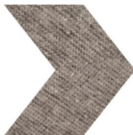
Figura 27 – Meia Malha - 75% Algodão Reciclado/ 25% PET Reciclado Fonte: Etex Têxtil
