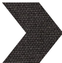
Figura 23 – Lona – 80% Algodão Reciclado/ 20% PET Reciclado Fonte: Etex Têxtil
