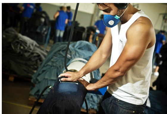
Figura 14 – Lixado manual na calça jeans.
