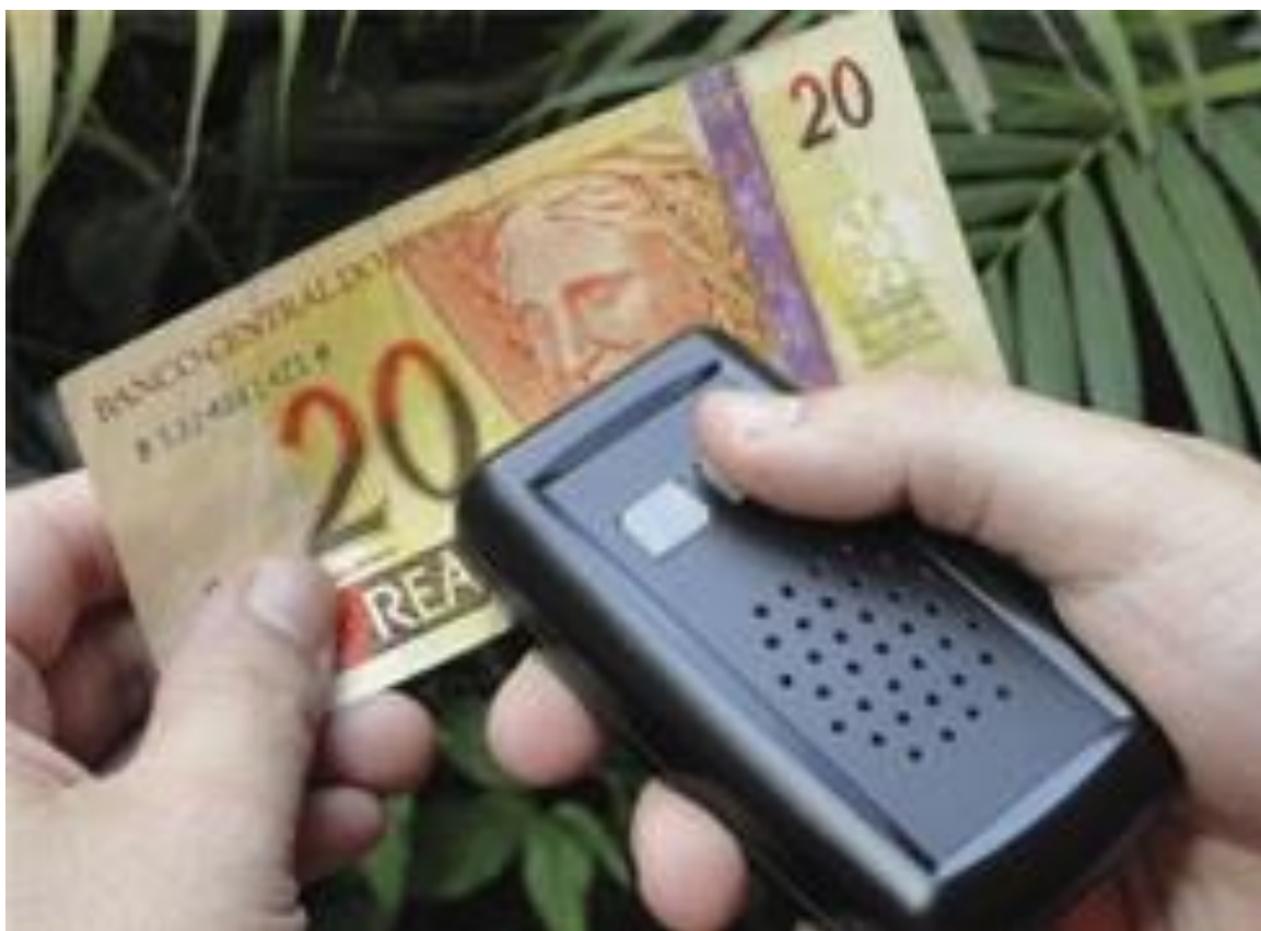
Figura 15 – Prisma – aparelho sonoro de leitura de cores e cédulas Fonte: Lab de Garagem (2015)
